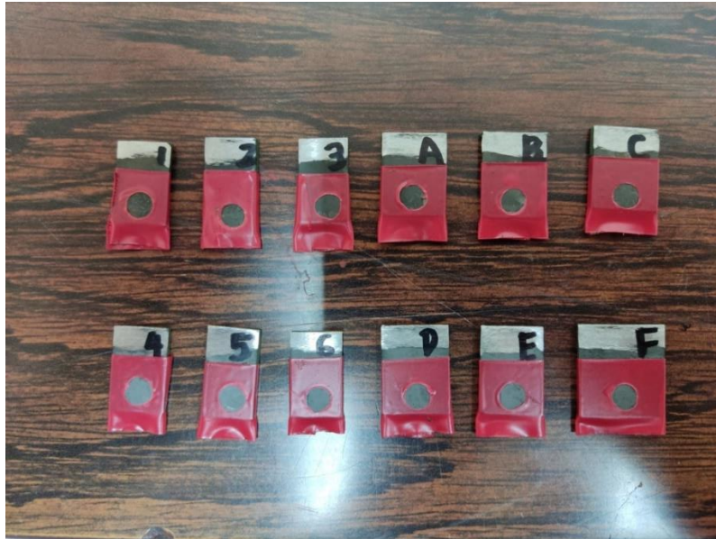
Εικόνα 30: Φωτογραφία της προετοιμασίας των δοκιμίων για την ηλεκτροχημική εξέταση (ηλεκτρόδια εργασίας). Πάνω είναι όλα τα δοκίμια που οξειδώθηκαν στους 750 οC και κάτω στους 950 οC (δεν απεικονίζονται τα δοκίμια αναφοράς). Όπως αναφέρθηκε η στρογγυλή επιφάνεια
