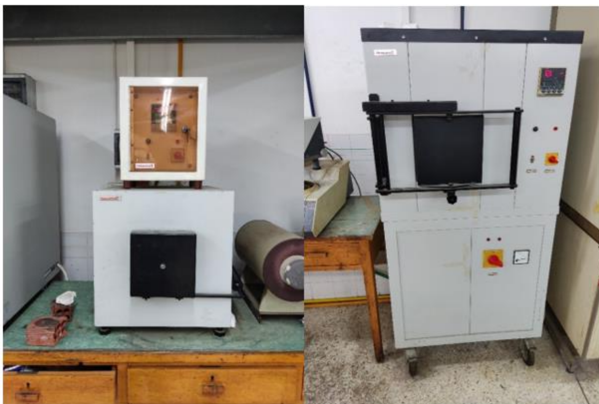
Εικόνα 25: Οι φούρνοι Thermawatt στους οποίους πραγματοποιήθηκε η οξείδωση των δοκιμίων.
