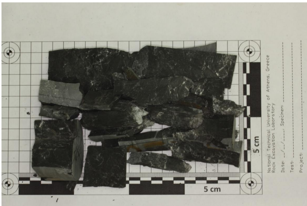
Φώτο Π.3.2. Το δοκίμιο Ta_02 έπειτα από την εκτέλεση της δοκιμής
