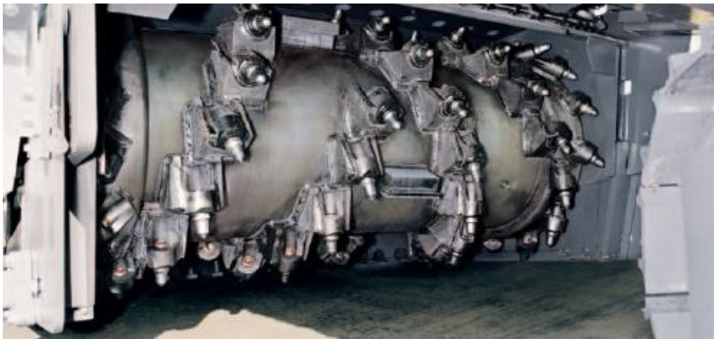
Φώτο 9.3. Κοπτικό τύμπανο του Surface Miner
