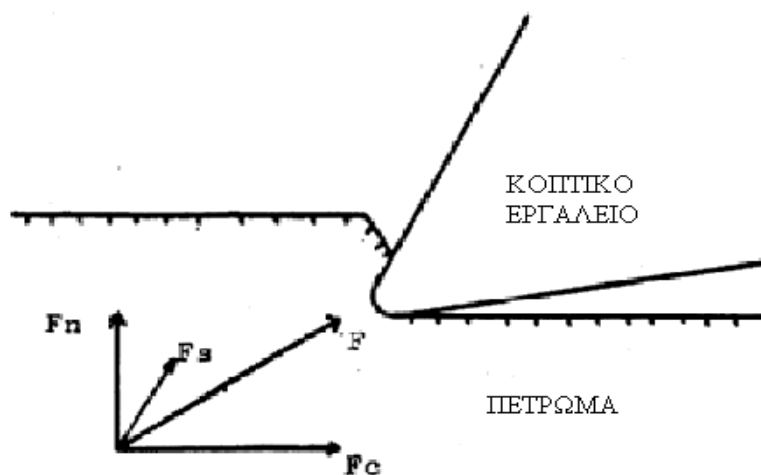
Σχήμα 4.4. Ανάλυση των δυνάμεων κατά την κοπή των πετρωμάτων
