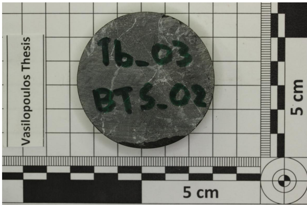
Φώτο Π.4.7. Το δοκίμιο Tb_03 bts_02 που δεν αστόχησε
