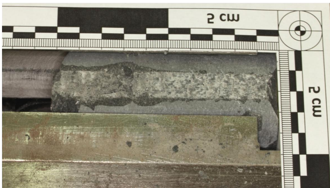
Φώτο Π.5.4. Τέταρτη γενέτειρα δοκιμίου Ta_04 (φορά κοπής από αριστερά προς δεξιά)
