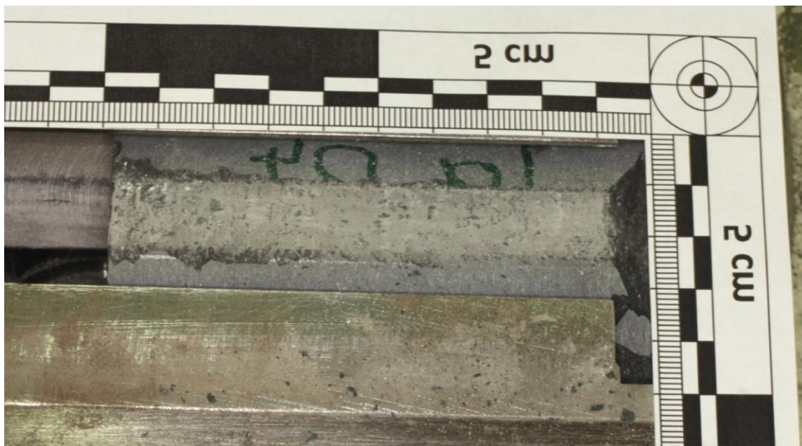
Φώτο Π.5.1. Πρώτη γενέτειρα δοκιμίου Ta_04 (φορά κοπής από αριστερά προς δεξιά)
