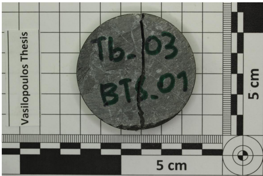
Φώτο Π.4.6. Το δοκίμιο Tb_03 bts_01 έπειτα από την εκτέλεση της δοκιμής
