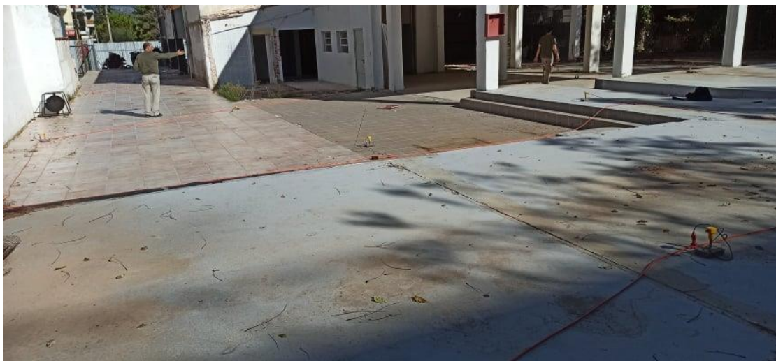
Εικόνα 93. Η διάταξη των γεωφώνων επί της γραμμής 2 στο πεδίο έρευνας συνδεδεμένα μεταξύ τους με καλώδια(από αριστερά προς τα δεξιά), ενώ διακρίνονται και τα μολύβδινα βαρίδια
