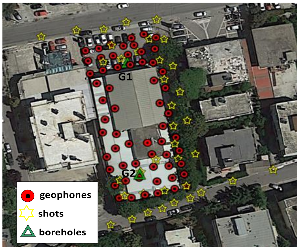
Εικόνα 70. Θέσεις τοποθέτησης των γεωφώνων(κόκκινες κουκίδες) και τα σημεία των κρούσεων(κίτρινα σηματάκια) με τη σεισμική πηγή στο χώρο της έρευνας. Παράλληλα φαίνονται και τα σημεία των δύο γεωτρήσεων(πράσινα τρίγωνα)
