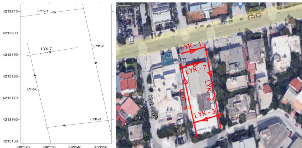
Εικόνα 3. Κάναβος μετρήσεων γεωραντάρ και δορυφορική απεικόνιση των πέντε ευθειών που ακολούθησε και οδήγησαν στη λήψη των αντίστοιχων τομών (κόκκινο χρώμα)
