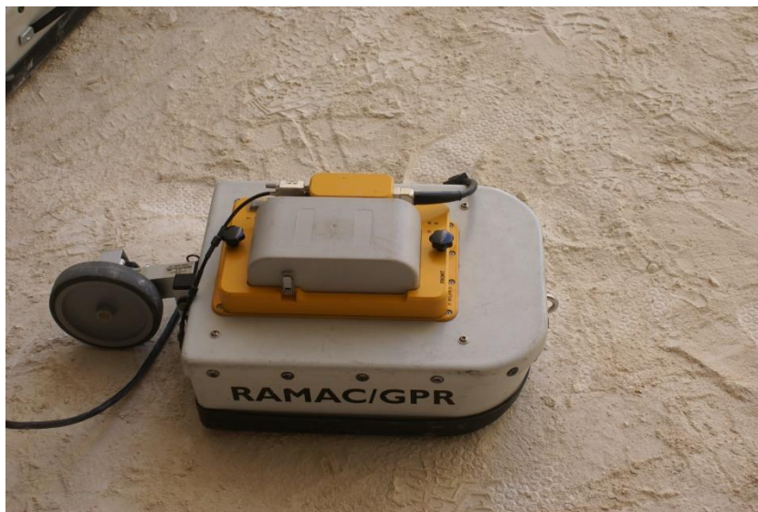
Εικόνα 39. Απεικόνιση ολοκληρωμένου συστήματος Γεωραντάρ, όπως αυτό χρησιμοποιήθηκε κατά τη Γεωφυσική Έρευνα στην περιοχή της Λυκόβρυσης
