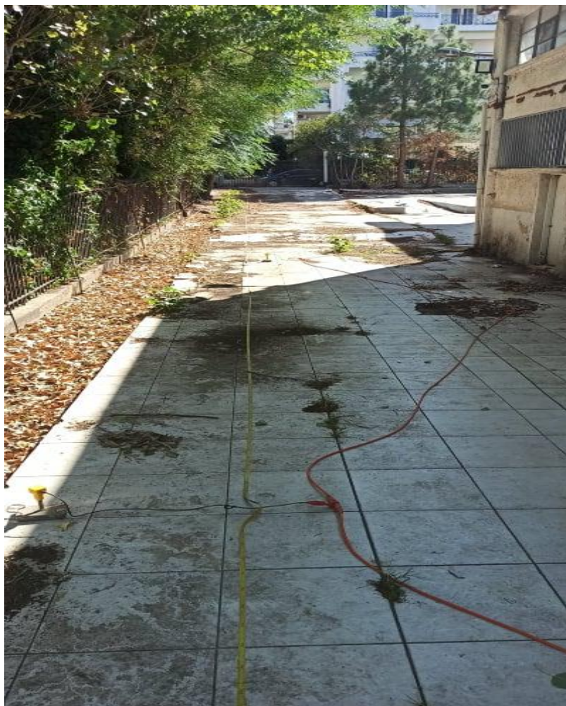
Εικόνα 73. Η διάταξη των γεωφώνων επί της γραμμής 1 στο πεδίο έρευνας συνδεδεμένα μεταξύ τους με καλώδια, ενώ στα αριστερά διακρίνονται και τα μολύβδινα βαρίδια
