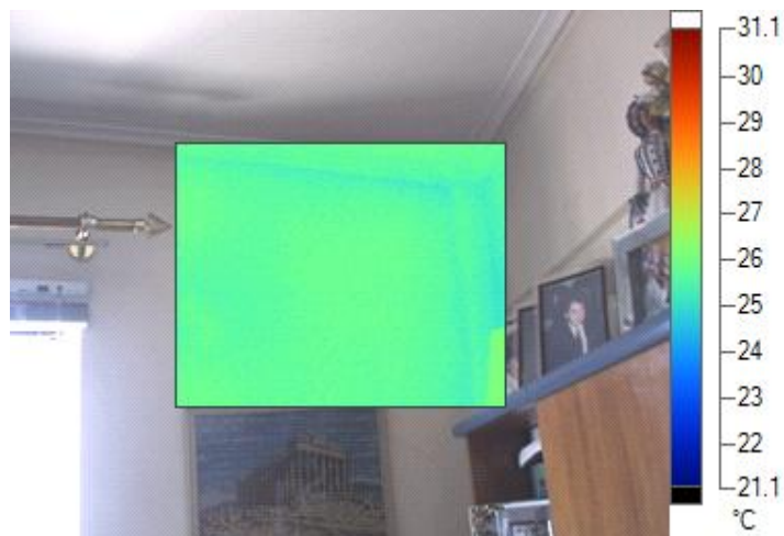
Εικόνα 6-15 Θερμοφωτογραφία τοίχου κ, ώρα 11:15μμ διαμερίσματος κατασκευής2000 ,εσωτερική όψη T_{avg} = 24,9^{\circ} C (εξωτερική όψη T_{avg} = 25^{\circ} )
