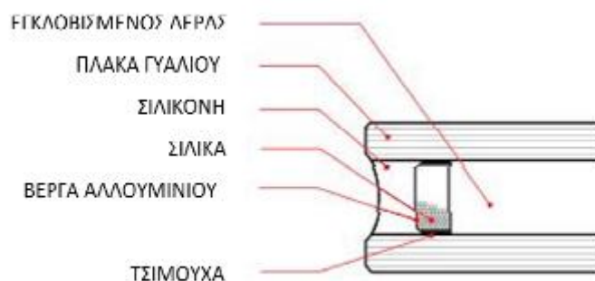
Σχήμα 2.6.2-1 Δομή διπλού γυαλιού ασφάλειας
