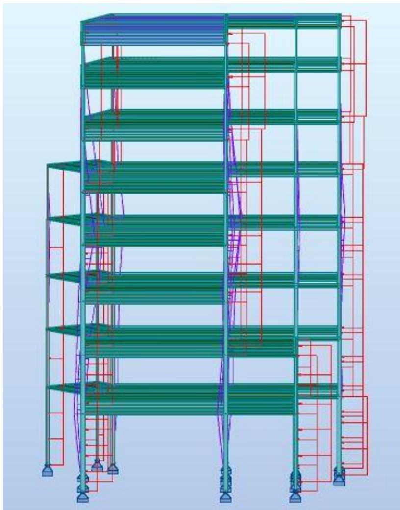
Σχήμα 5.17 Εξωτερική πίεση του ανέμου στην διεύθυνση -Υ
