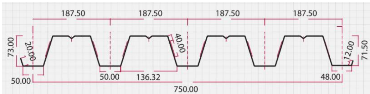
Σχήμα 3.2 Χαλυβδόφυλλο SymDeck 73
