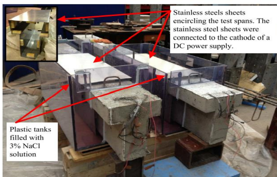
Σχήμα 2.3 Πειραματική διάταξη διάβρωσης οπλισμού
