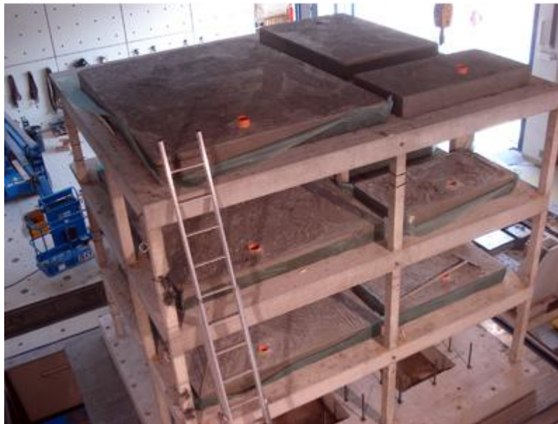
Σχήμα 4.5 : Πρόσθετες μάζες σκυροδέματος στις πλάκες των ορόφων
