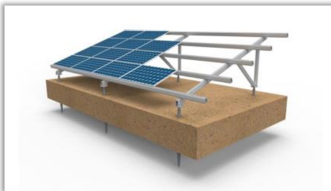
Εικόνα 3: Σταθερή βάση με βιδωτά θεμέλια Πηγή :[21]
