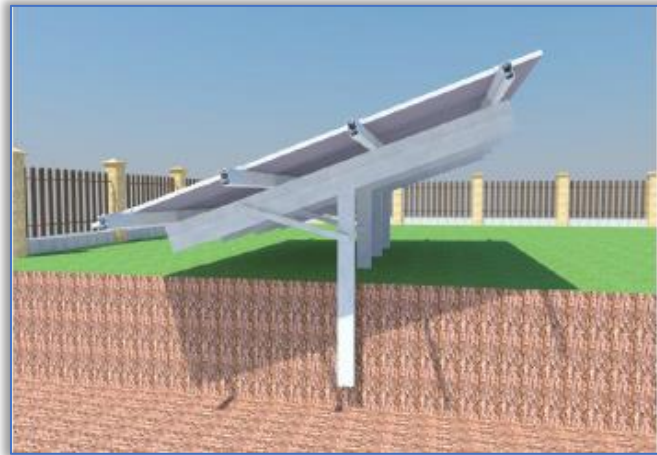
Εικόνα 2 :Θεμελίωση πλαισίου με πάσσαλο. Πηγή :[21]
