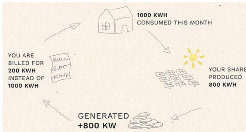
Εικόνα 25: Αποτύπωση της λειτουργίας του εικονικού ενεργειακού συμψηφισμού (Virtual net metering) Πηγή :[2]
