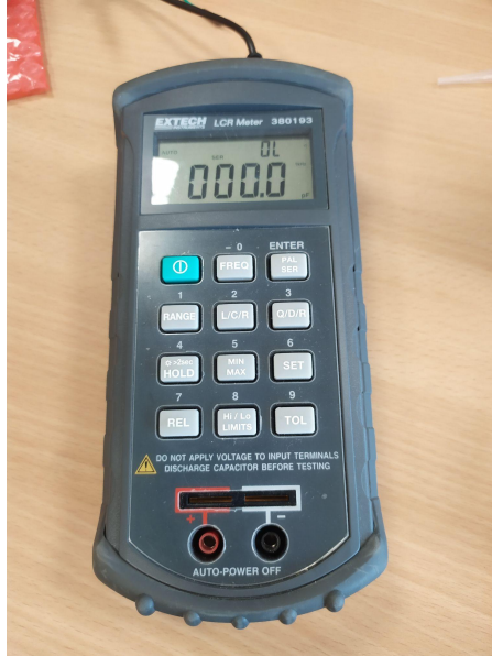
Σχήμα 6.1: Ο μετρητής αυτεπαγωγής, χωρητικότητας, αντίστασης (LCR) του εργαστηρίου.
