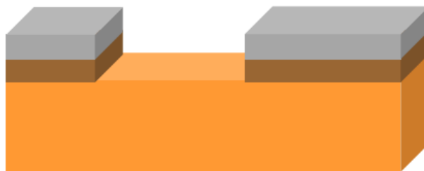
Σχήμα 5.4: Η φωτοευαίσθητη πλακέτα κατά το στάδιο της αποχάλκωσης.
