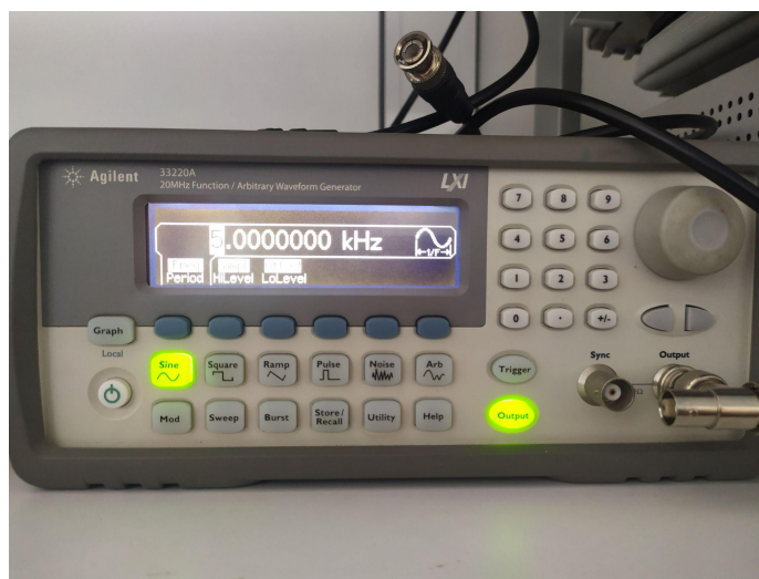
Σχήμα 6.24: Γεννήτρια του Εργαστηρίου Ηλεκτρονικών Αισθητηρίων ρυθμισμένη να τροφοδοτεί το κύκλωμα με ημιτονοειδές σήμα πλάτους 5V.
