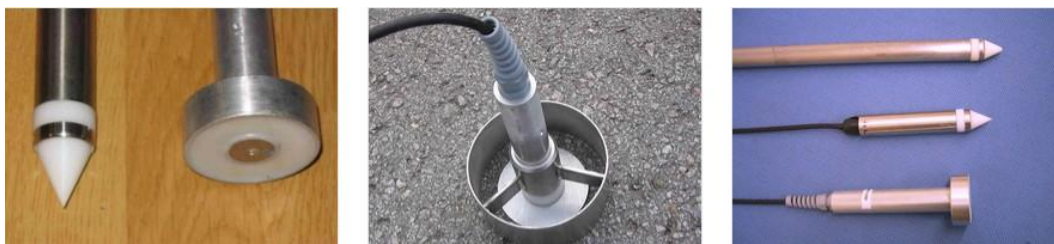
Εικόνα 3.3: Μερικά είδη ανιχνευτών Percometer
