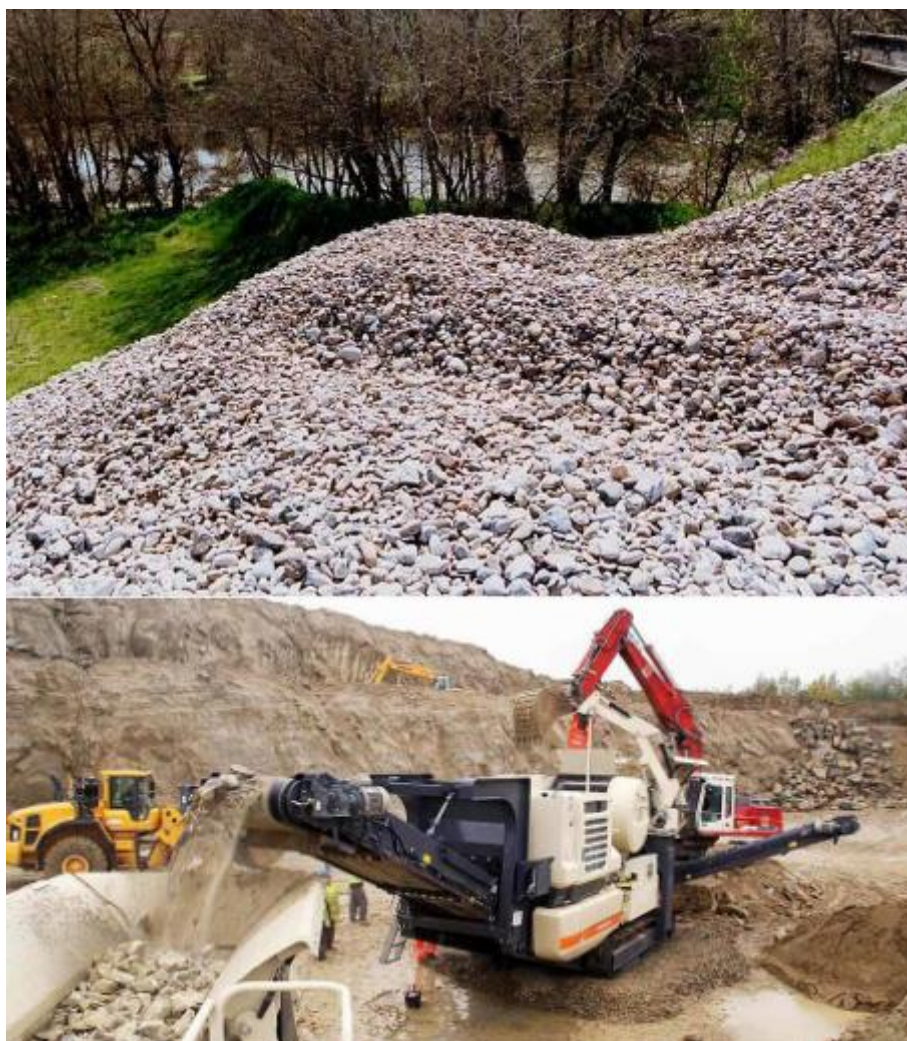
Εικόνα 2.5: Αδρανή υλικά: συλλεκτά (άνω) και θραυστά (κάτω)
