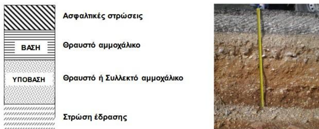
Εικόνα 2.3: Διατομή εύκαμπτου οδοστρώματος
