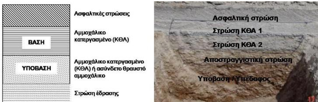
Εικόνα 2.2: Διατομή ημι-άκαμπτου/ημι-εύκαμπτου οδοστρώματος
