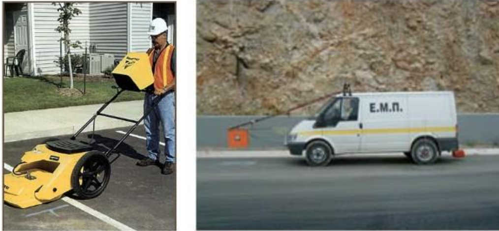
Εικόνα 3.4: Γεωφυσικό σύστημα GPR
