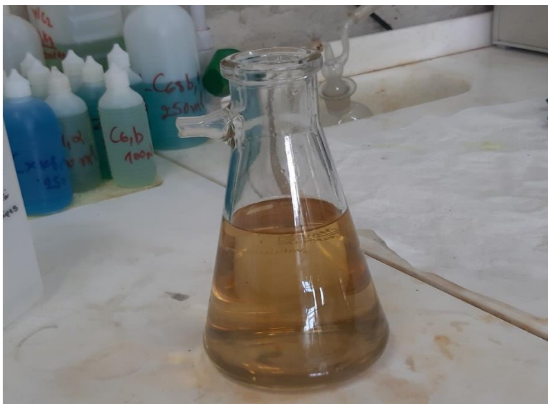
Εικόνα 6.10. Διάλυμα εκχύλισης πριν εισαχθεί στο αυτόκλειστο
