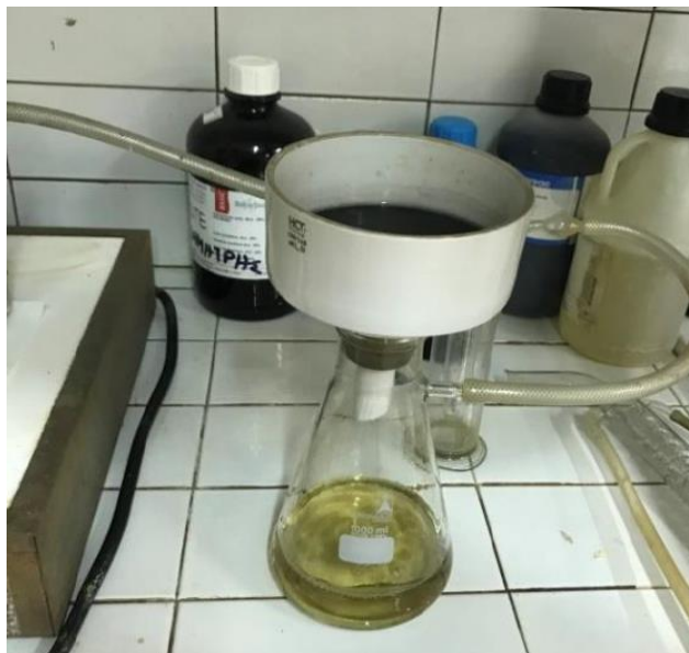
Εικόνα 6.6. Διήθηση του κυοφορούντος διαλύματος μετά από το πέρας της εκχύλισης
