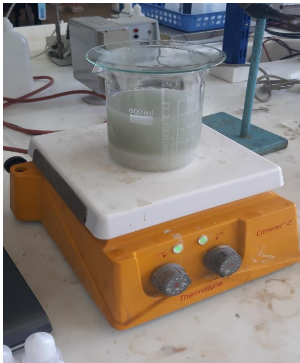
Εικόνα 6.3. Προετοιμασία του διαλύματος εκχύλισης (μαγνητική ανάδευση με ταυτόχρονη θέρμανση)
