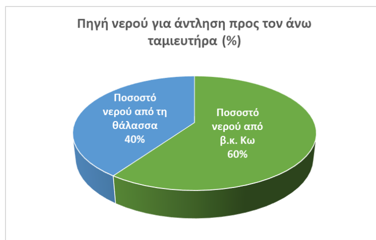
Σχήμα 5.23 Πηγή νερού για άντληση προς τον άνω ταμιευτήρα
