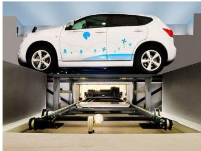
Σχήμα 2.26 Ανταλλαγή μπαταρίας από το κάτω μέρος του οχήματος (Πηγή: Βεντουρή, 2021)
