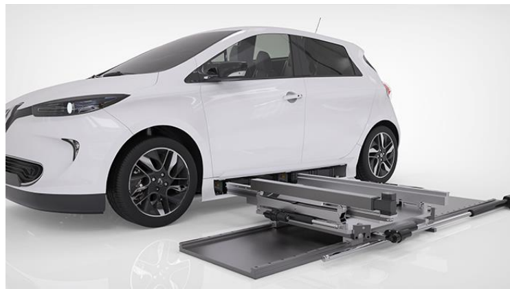
Σχήμα 2.24 Ανταλλαγή μπαταρίας από πλάγια (Πηγή: www.electronicsspecifier.com )
