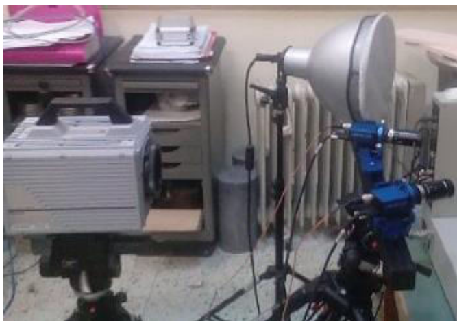
Εικ. 4.15: Στήσιμο High Speed Camera και 3D – DIC.
