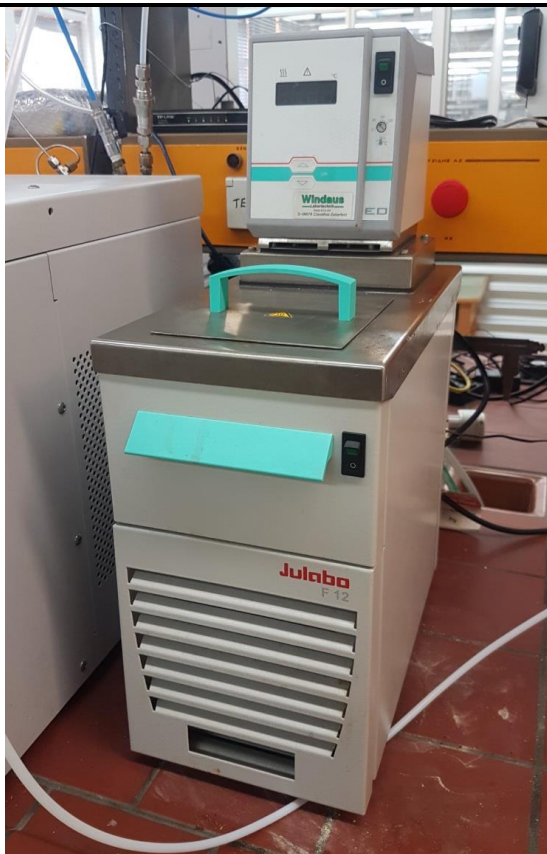
Εικόνα 16. Κυκλοφορητής ψύξης/ θέρμανσης
