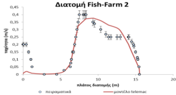
Εικόνα 4.5-7: Προφίλ ταχυτήτων πειραματικών μετρήσεων και προσομοίωσης στη δεύτερη διατομή ελέγχου στην έξοδο της το fish farm.
