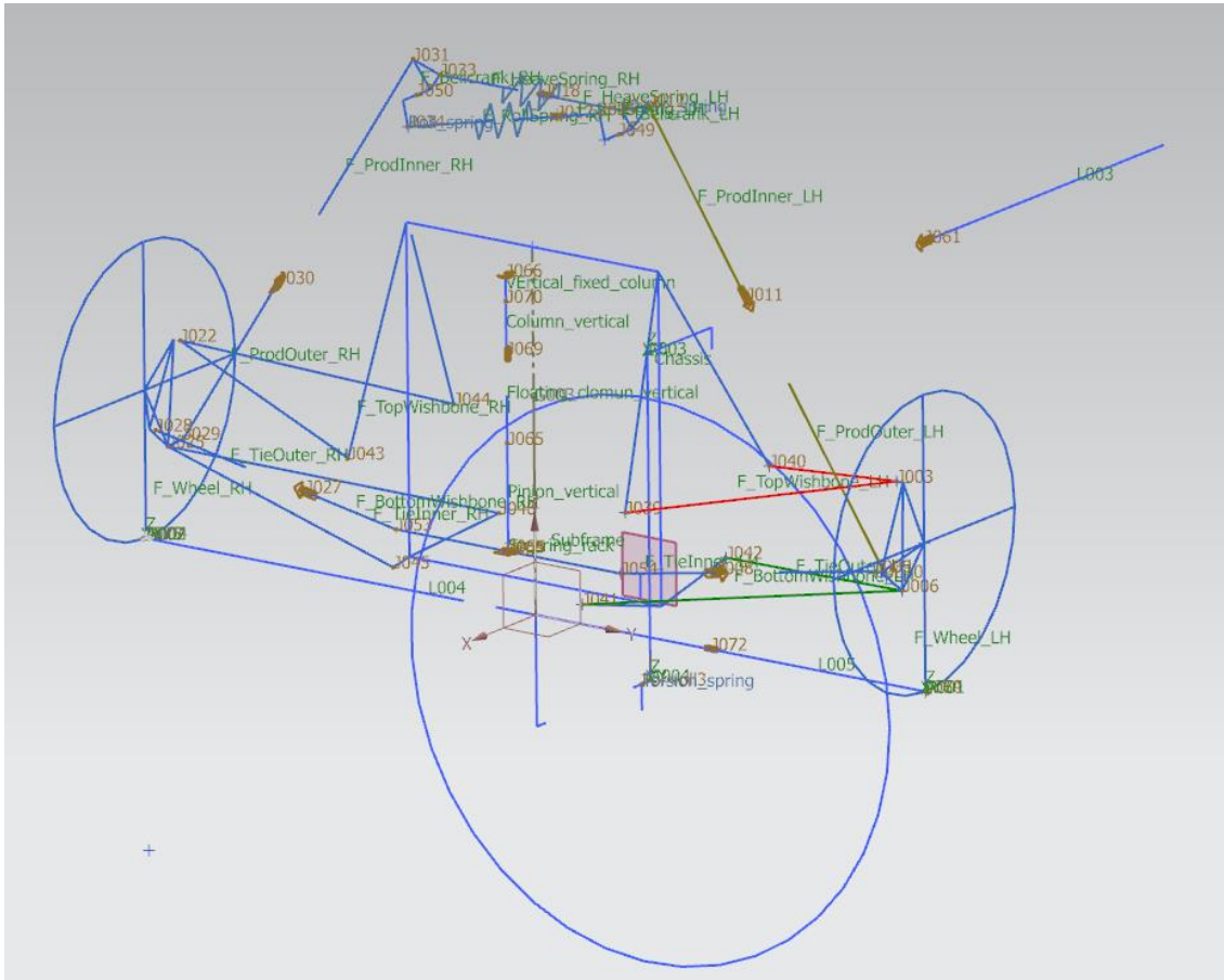
Σχήμα 3-6 - Σφαιρική εικόνα μοντέλου πεπερασμένων στοιχείων στο περιβάλλον Motion NX
