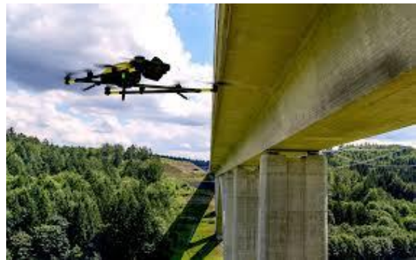
Σχήμα 1.3.4. Οπτική Επιθεώρηση με Drone (κάτω και πάνω)
