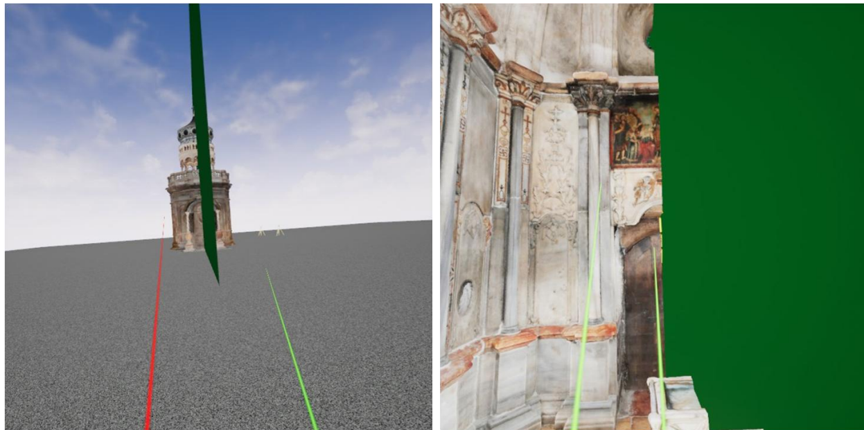
Εικόνα 3. 17: Ορισμός κατακόρυφου επιπέδου και επιλογή σημείων τομής στο εσωτερικό τμήμα του τρισδιάστατου μοντέλου
