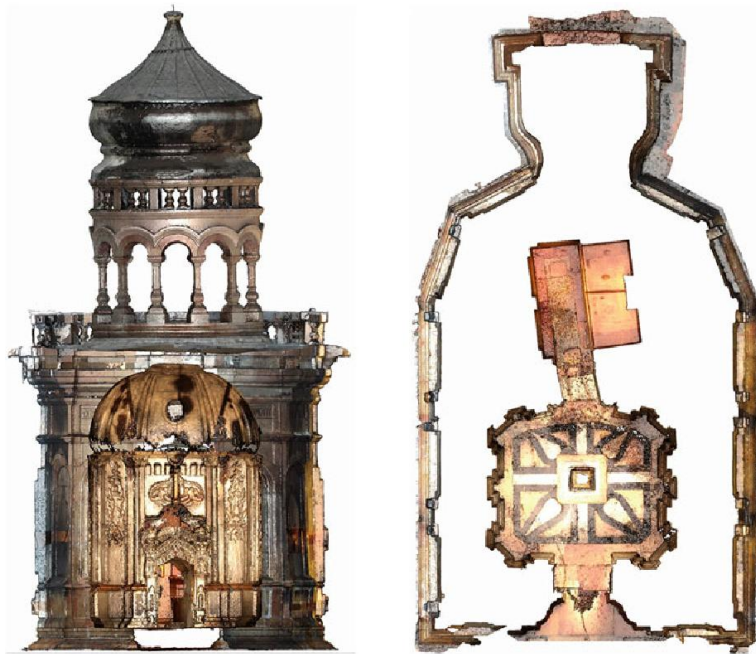
Εικόνα 3. 6: Κατακόρυφη (αριστερά) και Οριζόντια τομή (δεξιά) του τρισδιάστατου μοντέλου του Ιερού Κουβουκλίου του Παναγίου Τάφου (Moropoulou, Georgopoulos, Korres, Bakolas, et al., 2017).
