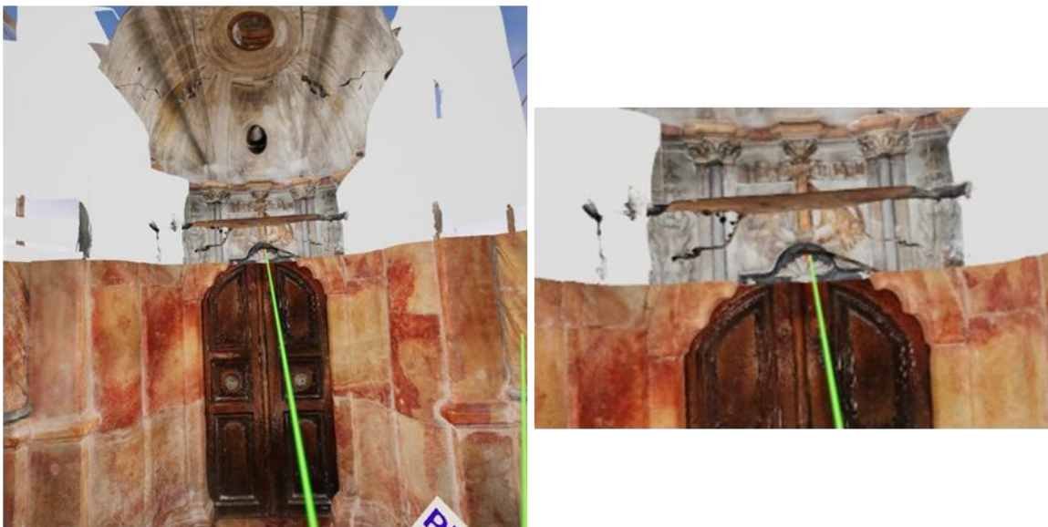
Εικόνα 3. 14: Απόκλιση σημείου τομής από το σημείο πρόσπτωσης της ακτίνας κατά τη σκόπευση στο ψηφιακό περιβάλλον της εφαρμογής (Η εικόνα δεξιά αποτελεί προϊόν μεγέθυνσης της αριστερής εικόνας)
