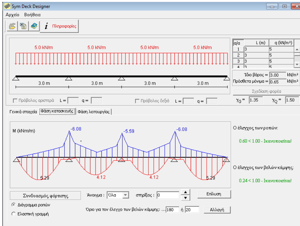
Εικόνα 4.27 Διάγραμμα ροπών κάμψης χαλυβδόφυλλων στη φάση κατασκευής
