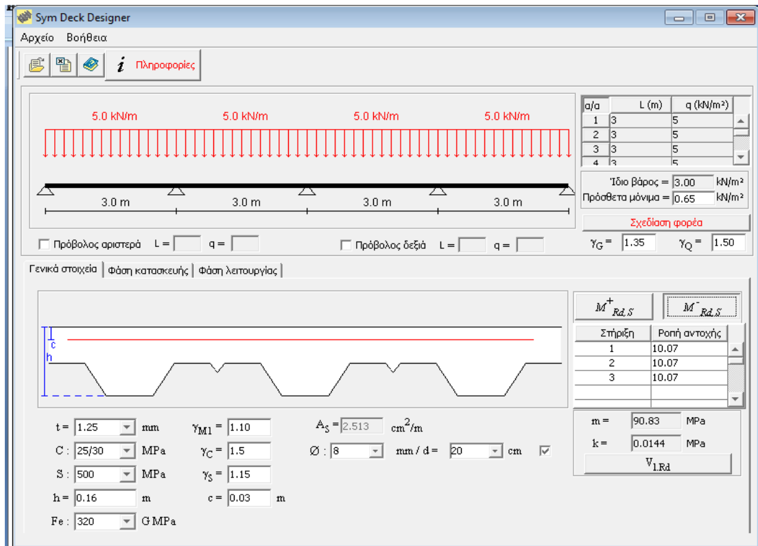
Εικόνα 4.25 Αρνητική ροπή αντοχής χαλυβδόφυλλου στη φάση κατασκευής
