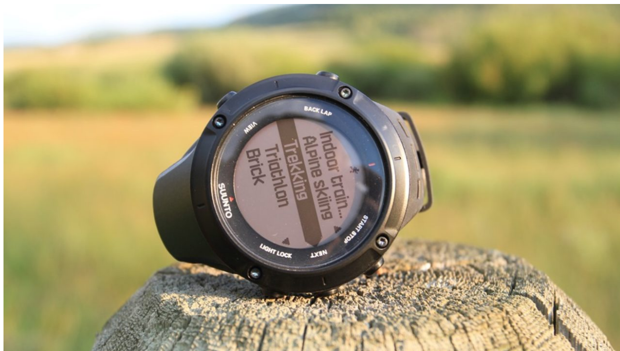
Εικόνα 44: Το εν λόγω ρολόι χειρός της εταιρείας Suunto ήταν ο δέκτης GPS που χρησιμοποιούσε ο γράφων για την καταγραφή θέσεων και διαδρομών κατά τη διάρκεια των ερευνών πεδίου
