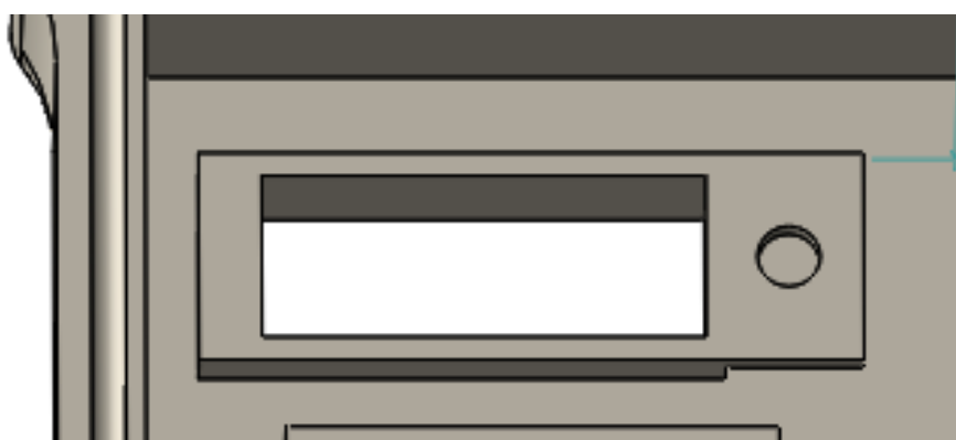
Σχήμα 26: Η βάση τοποθέτησης του αισθητήρα μέσα στο κάλυμμα
