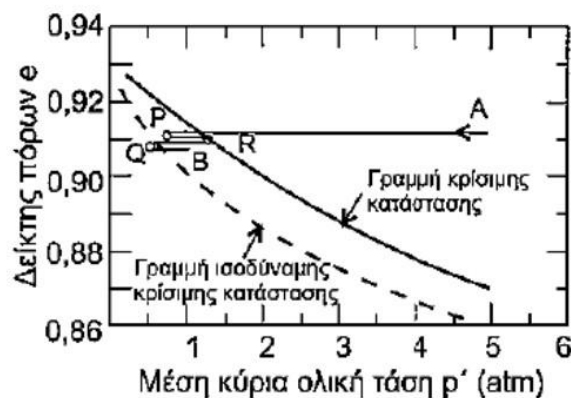
Διάγραμμα 1.2: Ισοδύναμη κρίσιμη κατάσταση και μεταβατική φάση μεταξύ συμπεριφοράς κρατυνόμενου και διασταλτικού τύπου, σε τριαξονική φόρτιση πολύ χαλαρής κορεσμένης άμμου Toyoura (Ishihara, 1993 στο Πιτιλάκης, 2010)
