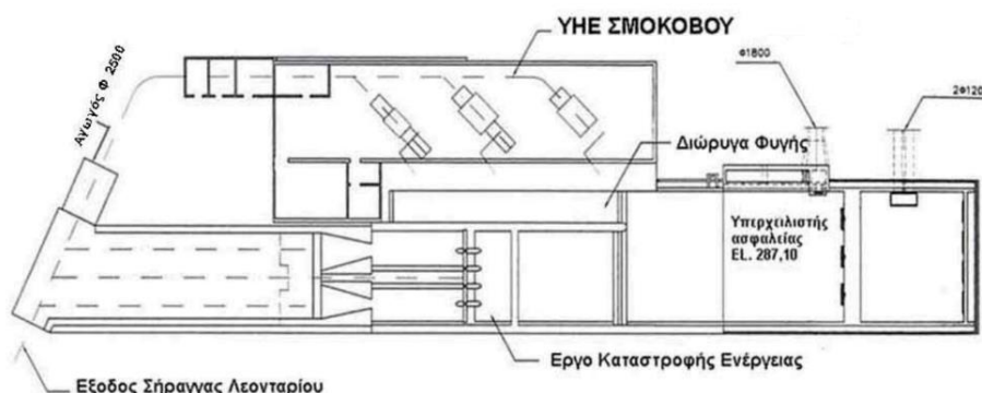
Εικόνα 2.21: Κάτοψη του ΜΥΗΣ Σμόκοβο-1 (Πηγή: ΔΕΗ, 2005)
