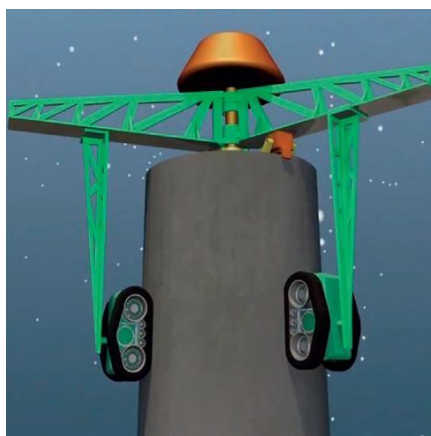
Εικόνα 2.1-13: Τεχνολογία CC για αυτοματοποιημένη κατασκευή ανεμογεννήτριας.
