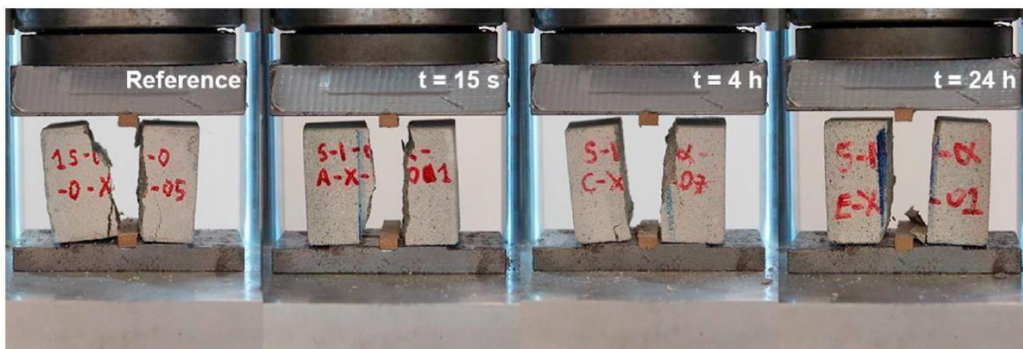
Εικόνα 2.2-11. Μοτίβα αστοχία σε δοκιμές αποκόλλησης για διάφορα χρονικά μεσοδιαστήματα εκτύπωσης.
