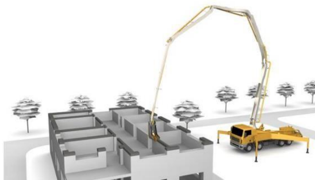
Εικόνα 2.1-5. Τροποποιημένη αντλία σκυροδέματος τοποθετημένη σε φορτηγό (Krause et al., 2018)
