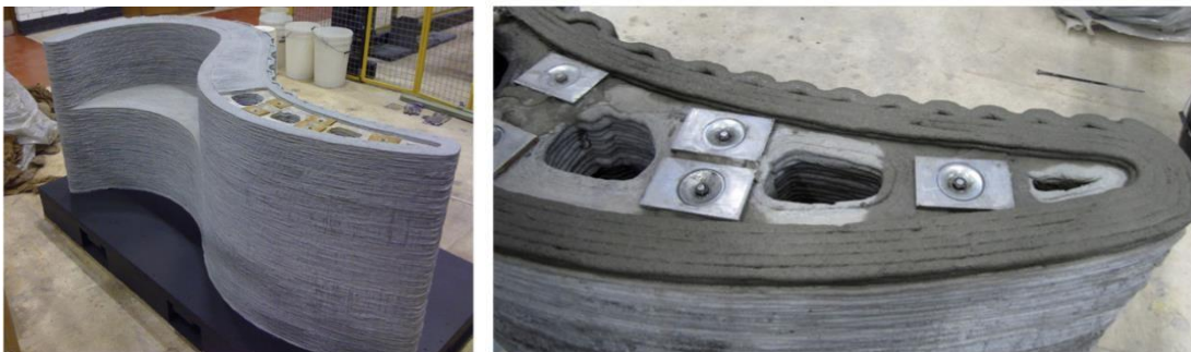
Εικόνα 2.1-4. Πάγκο μορφής τοίχου με την τεχνολογία Concrete Printing (Lim et al., 2012)
