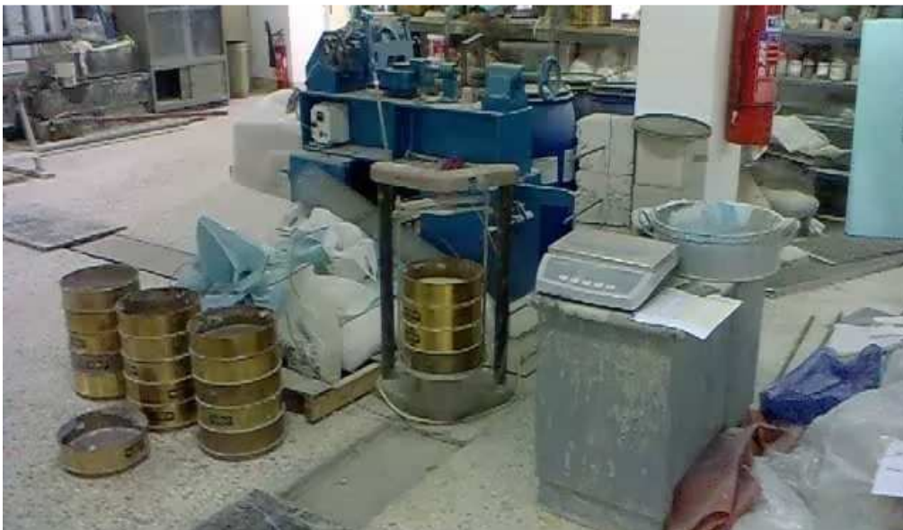
Εικόνα 2.3 Μηχανή κοσκινίσματος και κόσκινα Εργαστηρίου Ωπλισμένου Σκυροδέματος Ε.Μ.Π.
