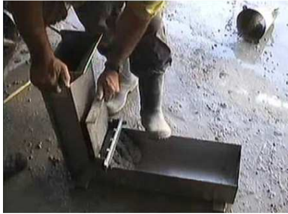
Εικόνα 1.11 Άνοιγμα θύρας δοχείου L.
