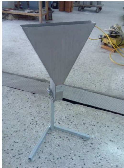
Εικόνα 1.9 Χοάνη V Εργαστηρίου Ωπλισμένου Σκυροδέματος Ε.Μ.Π. (πρόσθια όψη).
