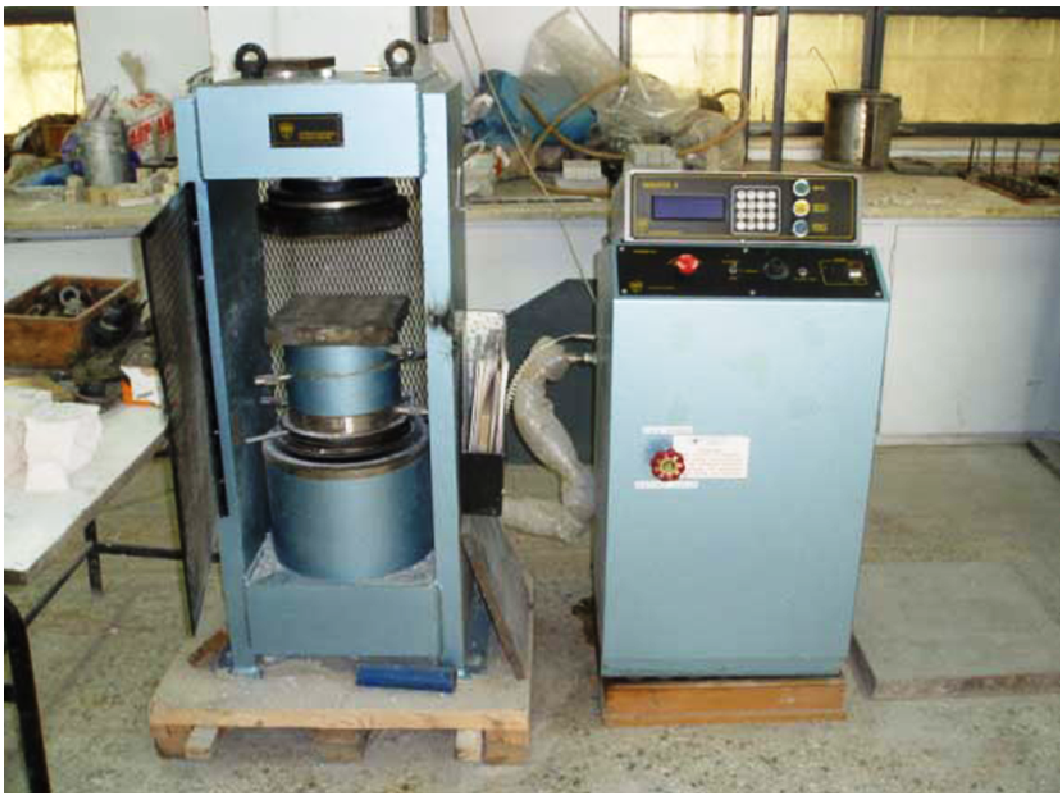
Εικόνα 2.8 Μηχανή θραύσης Wykeham Farrance του Εργαστηρίου Οπλισμένου Σκυροδέματος του Ε.Μ.Π.
