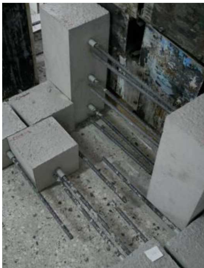
Εικόνα 2.6 Δοκίμια υποστύλωσης και κυβικά δοκίμια λίγο μετά το ξεκαλούπωμα.
