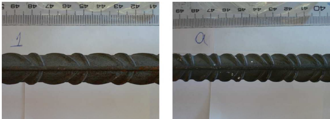
Εικόνα 1.28 Νευρώσεις τύπου 1 (αριστερά) και νευρώσεις τύπου 2 (δεξιά) (Βαγγελή και Χρηστάκης, 2008).
