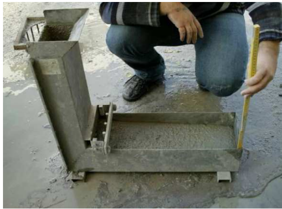
Εικόνα 1.12 Μέτρηση των υψών H_{1,L} και H_{2,L} .
