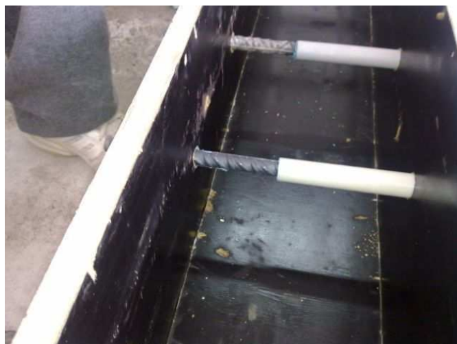
Εικόνα 2.5 Ευλότυπος δοκιμίου δοκού έτοιμος προς πλήρωση.
