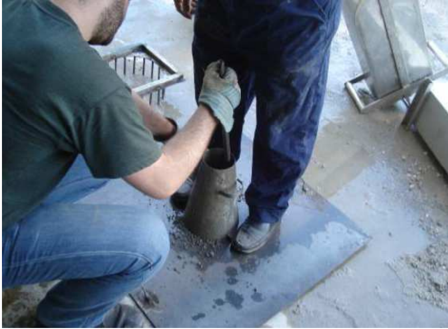
Εικόνα 1.5 Ραβδισμός σκυροδέματος κατά τη δοκιμή κάθισης.
