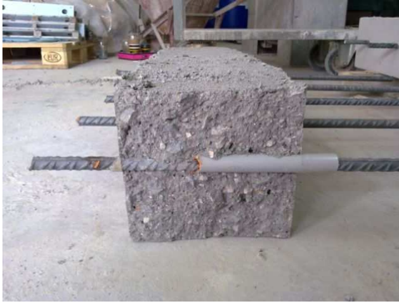
Εικόνα 2.10 Τμήμα δοκιμίου δοκού έπειτα από την αστοχία (για τη σύνθεση NC-11).
