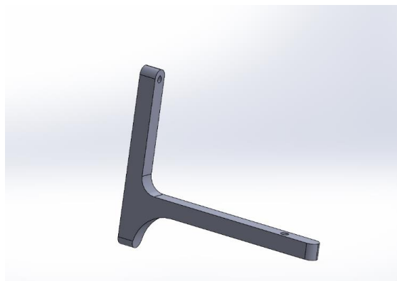
Εικόνα 3.10 Εξάρτημα στήριξης σαρωτή
