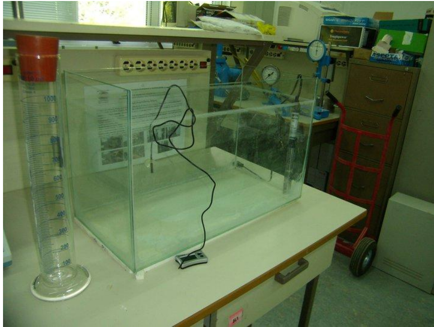
Σχήμα 2.13 Δοχείο υδατόλουτρου, ογκομετρικός κύλινδρος και θερμόμετρο ακριβείας.
