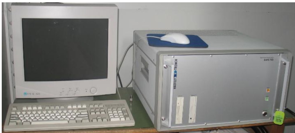
Σχήμα 2.5 Μετρητικό σύστημα HAEFELY DIAS 733.
