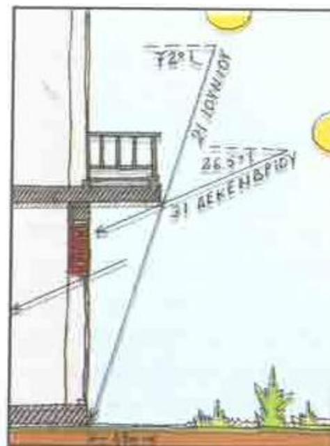
Εικόνα 6.5: Οριζόντιο σκίαστρο στο ύψος της άνω παρειάς του ανοίγματος [21]
