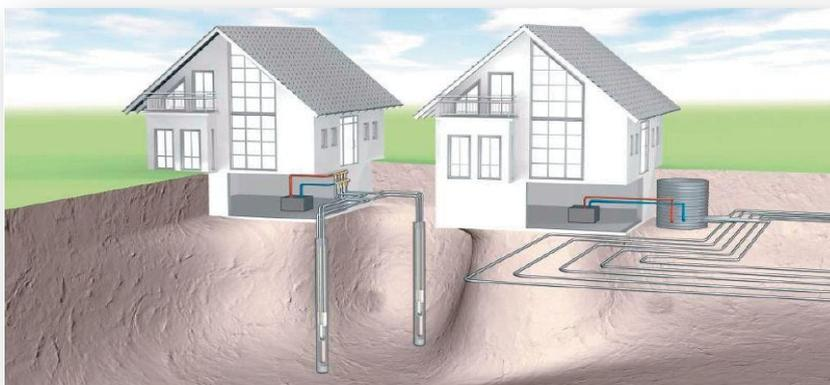
Εικόνα 9.5: Κατακόρυφες-οριζόντιες σωληνώσεις γεωθερμικού συστήματος σε κατοικία [153]
