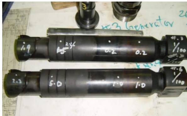
Εικόνα 10: Έμβολο με φθορά από χημική διάβρωση. Πηγή: MAN Diesel.
