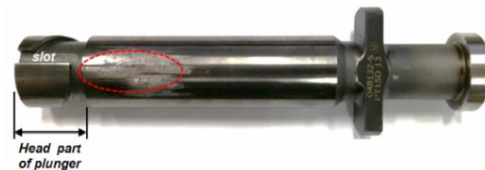
Εικόνα 7: Φθορά εξαιτίας απώλειας λιπαντικού φιλμ εξαιτίας χαμηλού ιξώδους. Πηγή: [6]
