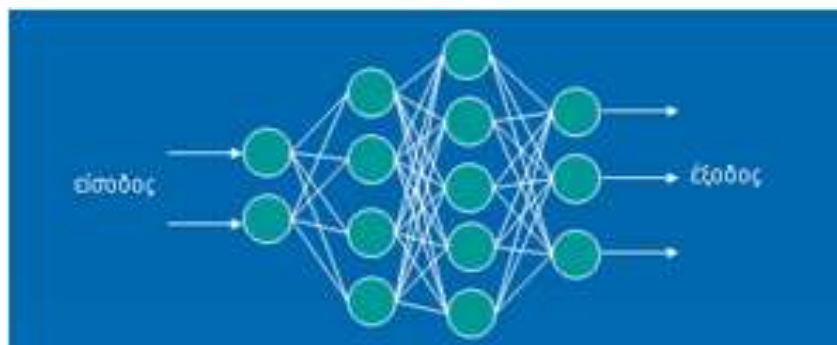
Σχήμα 3.7: Απλό μοντέλο feed-forward νευρωνικού δικτύου. (πηγή: http:// http://www.mediamax.gr/articles )
