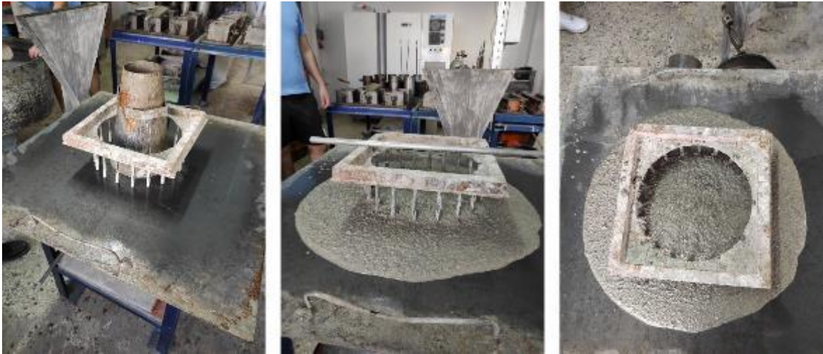
Εικόνα 2.6 Ενδεικτικές φωτογραφίες από τη δοκιμή δακτυλίου J (J-Ring).
