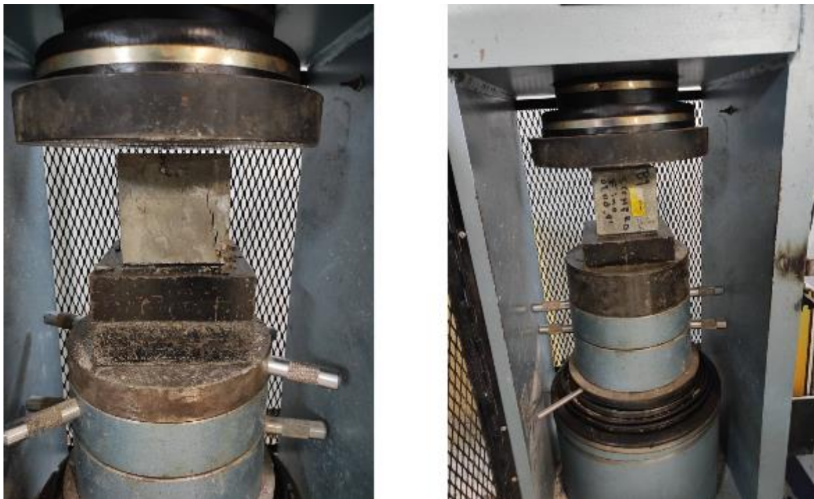
Εικόνα 2.8 Ενδεικτικές φωτογραφίες από τη δοκιμή θλιπτικής αντοχής.
