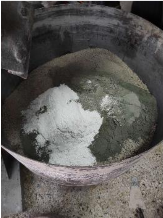
Εικόνα 2.1 Ενδεικτικές φωτογραφίες από τη διαδικασία σύνθεσης και ανάμιξης των υλικών του ΑΣΣ όπως πραγματοποιήθηκε στο εργαστήριο.
