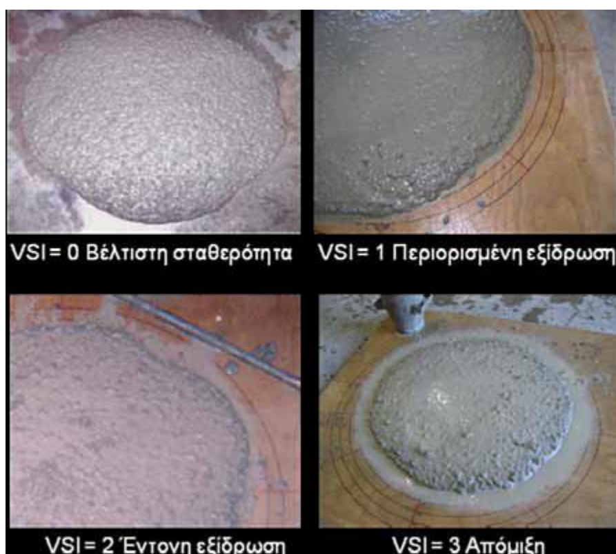
Εικόνα 1.11 Παραδείγματα απόδοσης ΟΔΣ σε εξαπλωμένα δείγματα ΑΣΣ [3]
