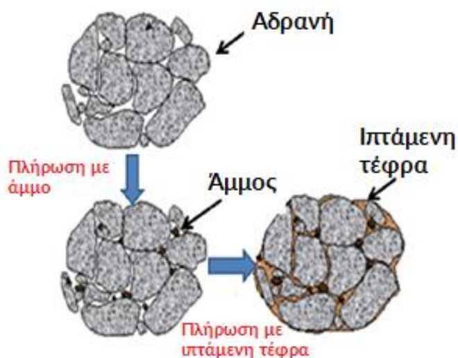
Εικόνα 1.10 Σχηματική απεικόνιση της διαδικασίας αδρανειακής στοίβαξης
