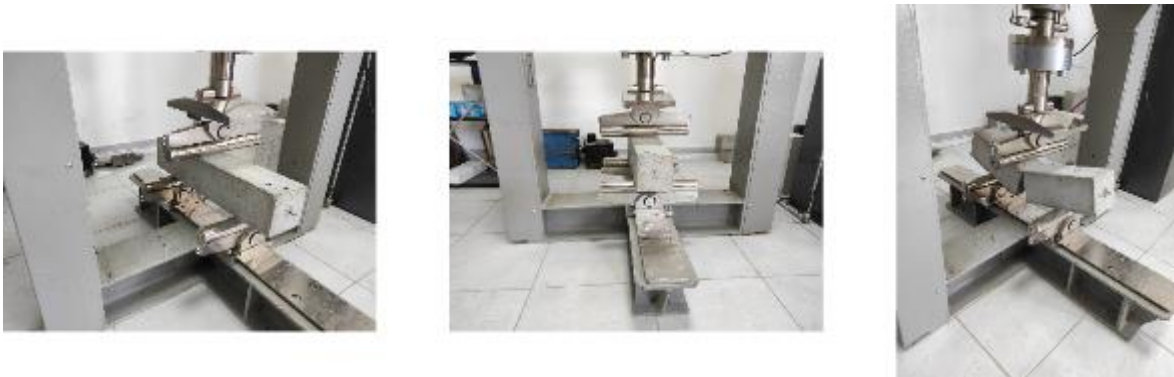
Εικόνα 2.14 Δοκιμή κάμψης πρισματικού δοκιμίου ηλικίας 90 ημερών.
