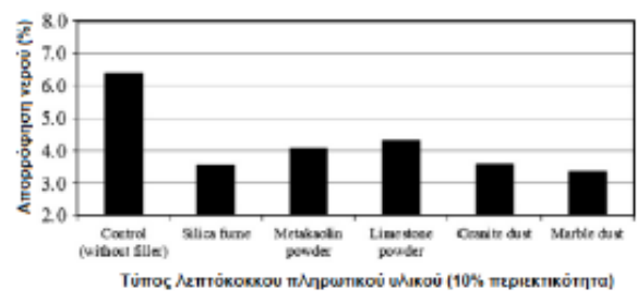
Σχήμα 1.12 Διαγράμματα ποσοστού εξίδρωσης και απορρόφησης νερού ως προς τους διαφορετικούς τύπους λεπτόκοκκων πληρωτικών υλικών με ποσοστό περιεκτικότητας 10%
