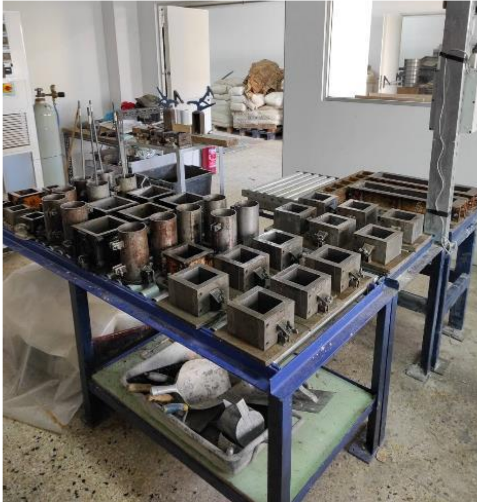
Εικόνα 2.2 Φωτογραφία των χαλύβδινων μητρών που χρησιμοποιήθηκαν στο εργαστήριο για την παρούσα εργασία
