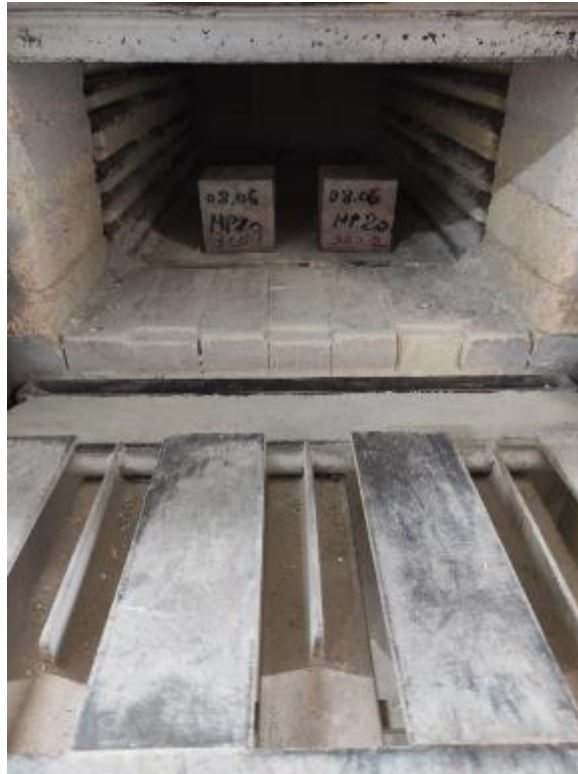
Εικόνα 2.9 Ενδεικτική φωτογραφία κατά την τοποθέτηση των δοκιμίων στον κλίβανο
