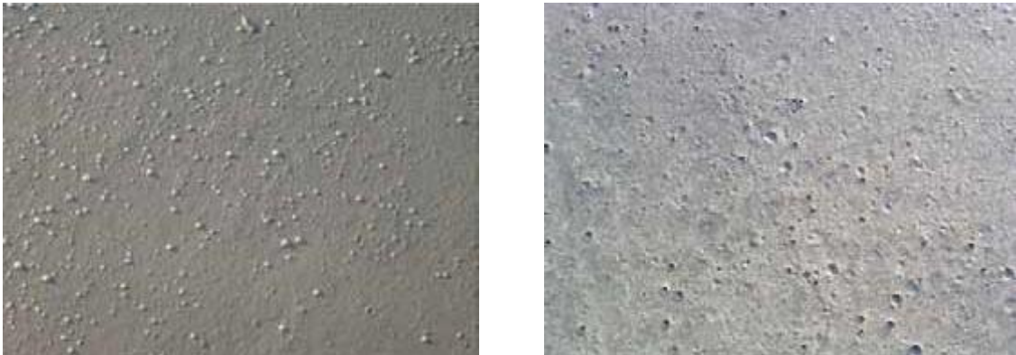
Εικόνα 1.8 Φυσαλίδες σε επιφάνεια νοπού ΑΣΣ σε επίπεδο στοιχείο και τα αποτυπώματά τους στην ίδια επιφάνεια μετά το πέρας της πήξης (Peterson, 2008).
