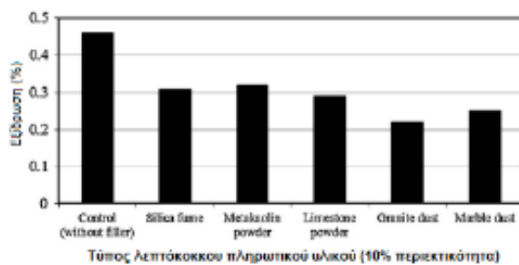
Σχήμα 1.12 Διαγράμματα ποσοστού εξίδρωσης και απορρόφησης νερού ως προς τους διαφορετικούς τύπους λεπτόκοκκων πληρωτικών υλικών με ποσοστό περιεκτικότητας 10%
