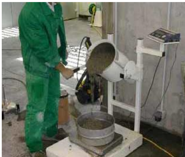
Εικόνα 1.16 Τυπικός εξοπλισμός δοκιμής σταθερότητας μέσω κοσκίνισης [3]
