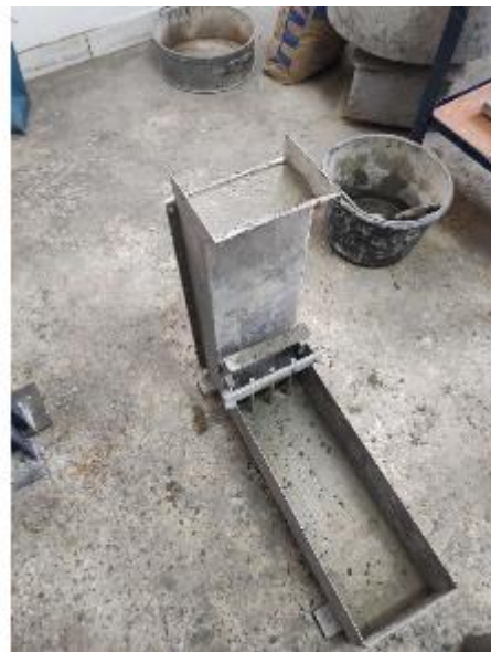
Εικόνα 2.5 Ενδεικτικές φωτογραφίες από τη δοκιμή δοχείου L (L-Box).
