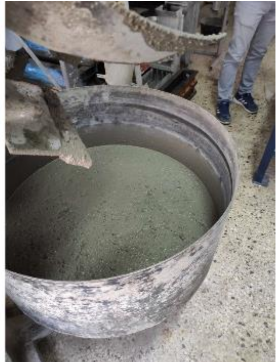
Εικόνα 2.1 Ενδεικτικές φωτογραφίες από τη διαδικασία σύνθεσης και ανάμιξης των υλικών του ΑΣΣ όπως πραγματοποιήθηκε στο εργαστήριο.
