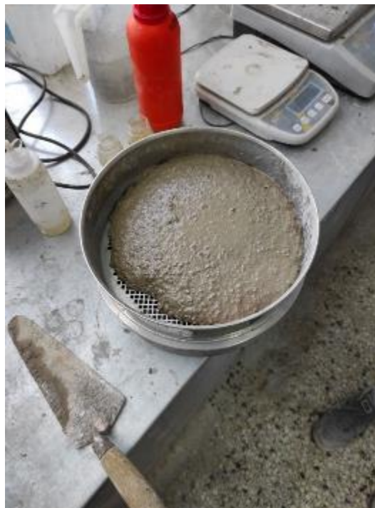
Εικόνα 2.7 Ενδεικτική φωτογραφία της δοκιμής σταθερότητας μέσω κοσκίνισης (sieve segregation resistance ή sieve stability test).
