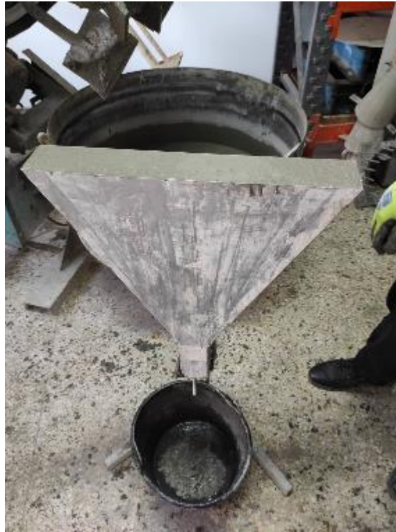
Εικόνα 2.4 Ενδεικτική φωτογραφία από τη δοκιμή χοάνης V.
