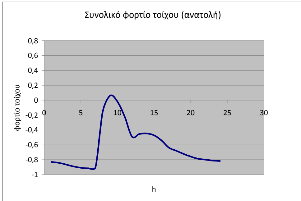
Διάγραμμα 8.5.3.4 Συνολικό φορτίο τοίχων ( K_{τοιχ} ) ανά ώρα για την 21 η Ιανουαρίου και για προσανατολισμό την ανατολή.
