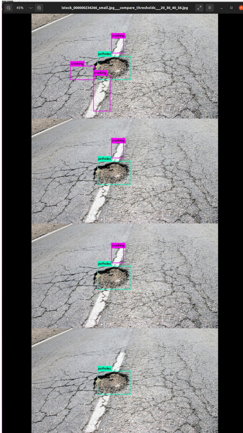
Εικόνα 37 : Παράδειγμα ανίχνευσης κλάσεων ανωμαλιών ξεκινώντας από πάνω με threshold=20 φτάνοντας προς τα κάτω με threshold=56
