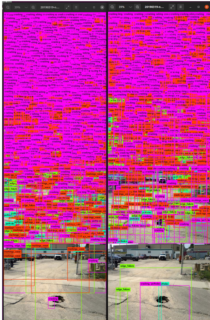
Εικόνα 42 : Πλέγμα 2x4 εικόνων όπου στις στήλες έχουμε παραμέτρους batch=64, subdivision=8 για την 1η στήλη και batch=64, subdivision=8 για την 2η στήλη και τιμές threshold= 20,30,40,56 από πάνω προς τα κάτω. Η αριστερή στήλη αναφέρεται σε ανιχνεύσεις με training από το υποσύνολο του dataset και η δεύτερη από το πλήρες
