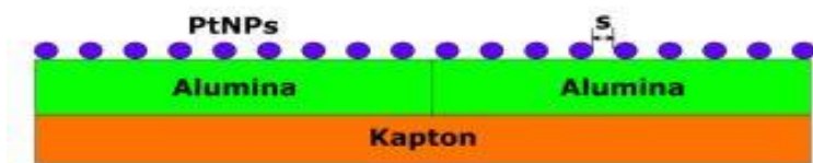
Εικόνα 17: Σχήμα Διατομής όταν ο αισθητήρας είναι χωρίς παραμόρφωση
