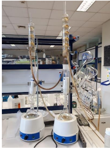
Εικόνα 26: Διάταξη της Soxhlet.
