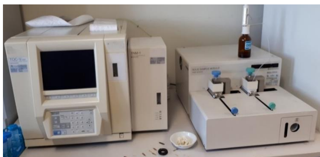
Εικόνα 32: Συσκευή μέτρησης TOC.
