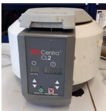
Εικόνα 28: Φυγόκεντρος IEC CENTRA CL2.
