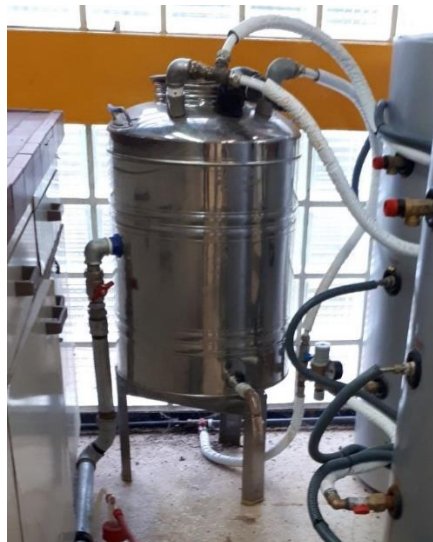
Εικόνα 22: Εναλλάκτης θερμότητας για την συμπύκνωση της αιθανόλης.
