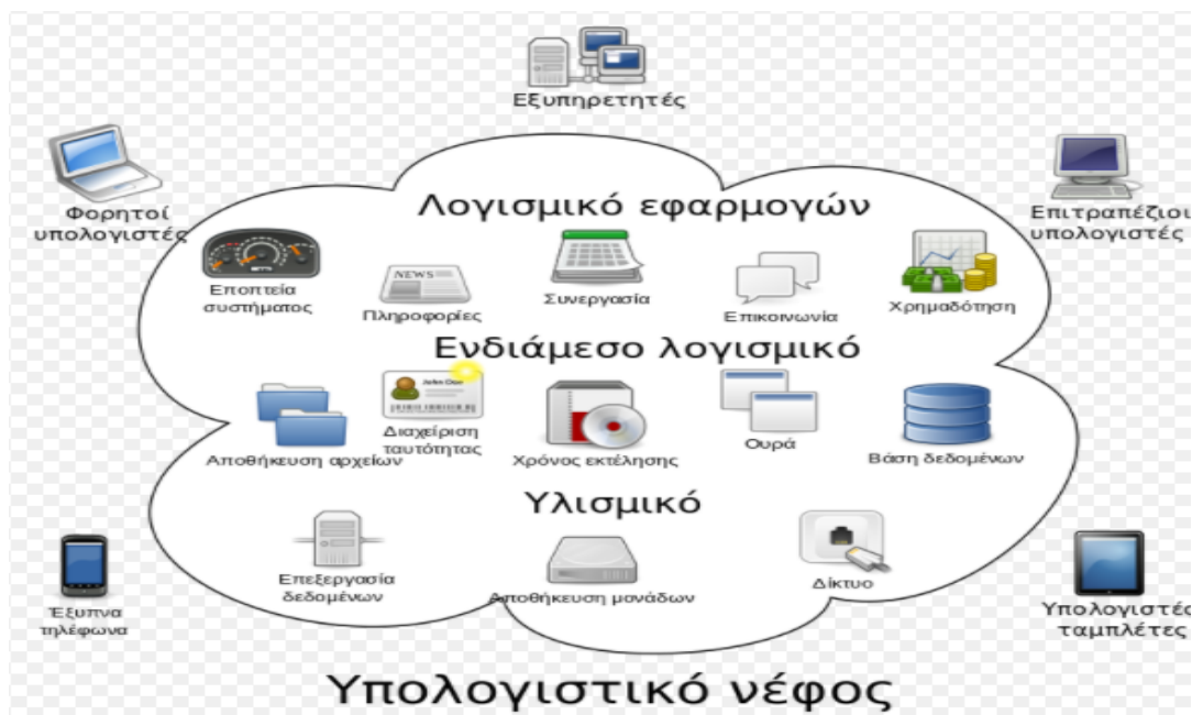
Εικόνα 5: Σχηματικό διάγραμμα της λειτουργίας ενός υπολογιστικού νέφους
