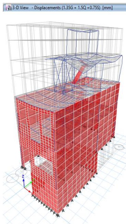
Σχήμα 7.7: Παραμορφωμένος φορέας υπό το συνδυασμό 1.35g + 1.5q + 0.75s
