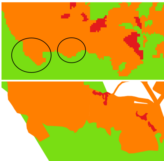
Εικόνα 14: Ενδεικτική περίπτωση ορθών αποτελεσμάτων ταξινόμησης (πάνω) συγκριτικά με τα δεδομένα αναφοράς CEMS (κάτω). Στο μαύρη έλλειψη επισημαίνεται η περιοχή ορθής ταξινόμησης.
