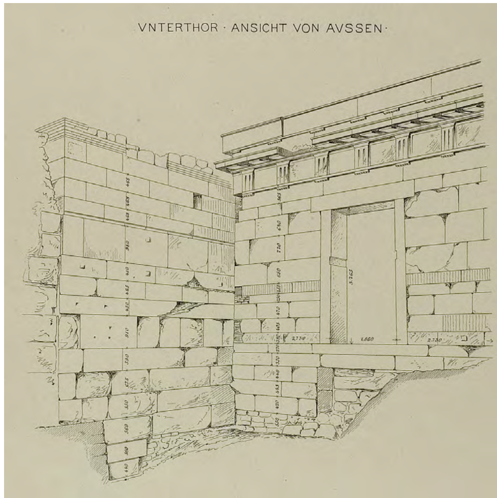
1) Προοπτικό σχέδιο αποτύπωσης της ανασκαφής του Bohn (1882, Πίν. XX) στο τμήμα μεταξύ της υστερορωμαϊκής πύλης και της νότιας όψης του βόρειου πύργου. Με διαγώνια διαγράμμιση επισημαίνονται προγενέστερα κατάλοιπα της οχύρωσης.
