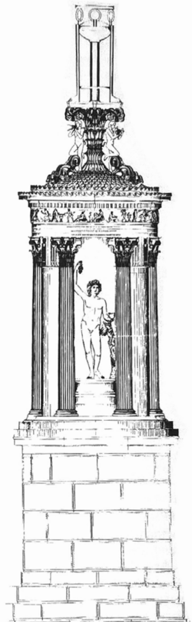
4) Χορηγικό μνημείο του Λυσικράτους, πρόταση γραφικής αποκατάστασης ως θόλου στέγασης ενός αγάλματος του Διονύσου με ελεύθερο το μετακίονιο διάστημα προς την οδό των Τριπόδων (Bauer, 1977, Πίν. 9).
