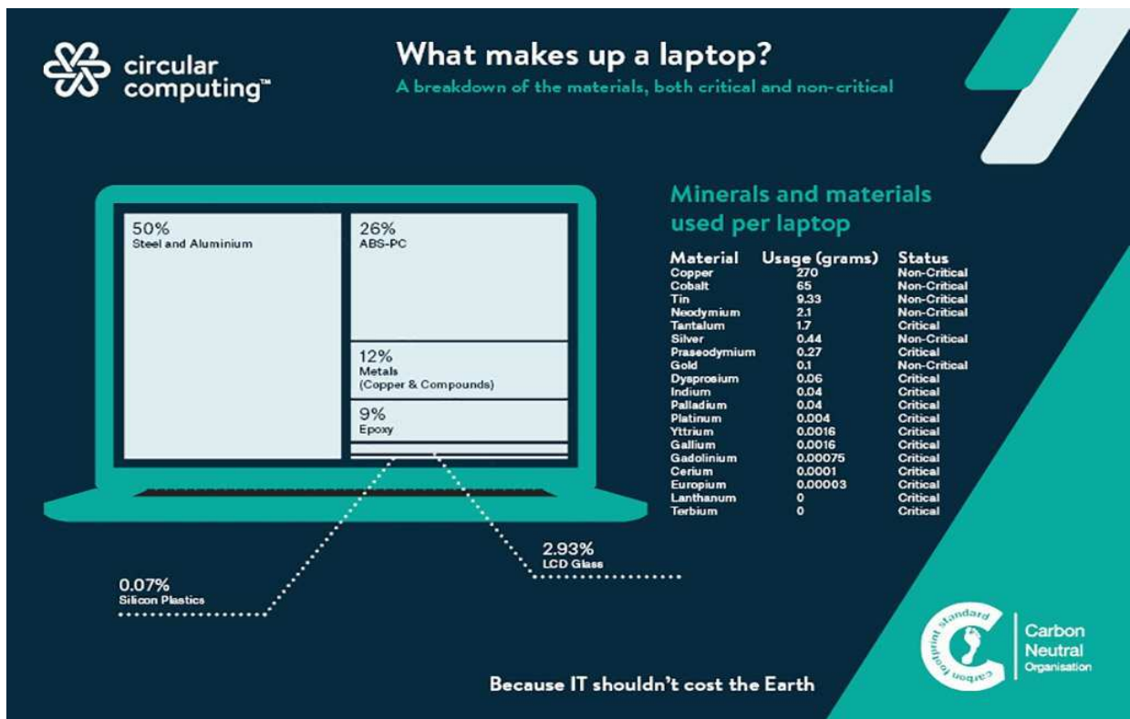
Εικόνα 5.2: Σύσταση ενός τυπικού φορητού υπολογιστή [32].
