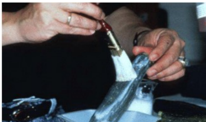
Εικόνα 5. Μέθοδος brushing για εφαρμογή μεμβράνης.
