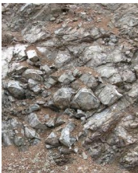
Εικόνα 3.7. Τμήμα περιδοτίτη στην περιοχή Όθρυος, με αδιατάρακτη δομή και μέτρια κατάσταση ασυνεχειών. Αναμενόμενη τιμή GSI = 65. Άντληση από: (Μπαλάση, 2007)
