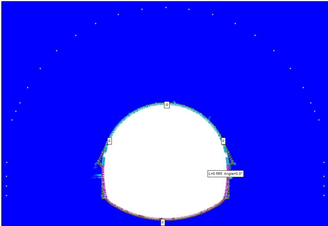
Εικόνα 5.23. Ανάπτυξη πλαστικής ζώνης περιμετρικά της εκσκαφής για τον Τύπο 4 οφιολίθων για H = 150m .
