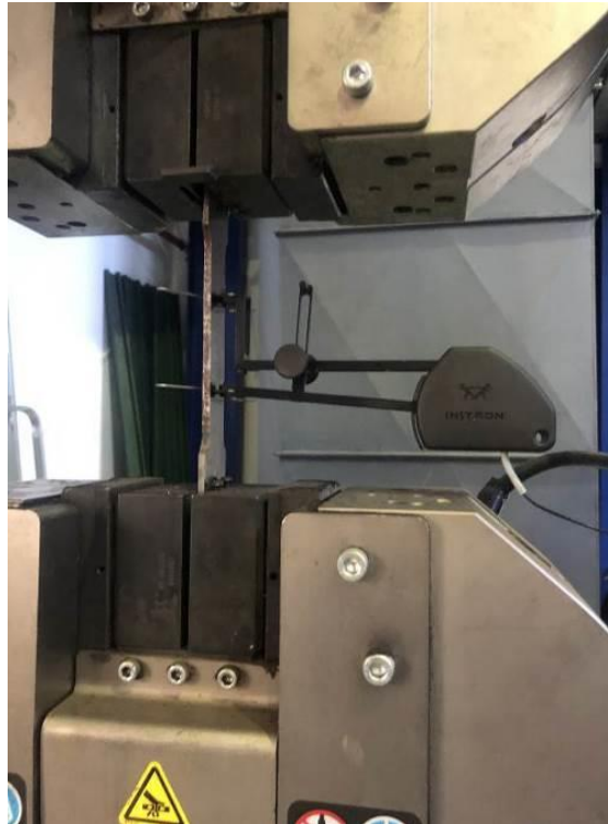
Εικόνα 6-6: Τοποθέτηση μηκυσιομέτρου σε δοκίμιο.
