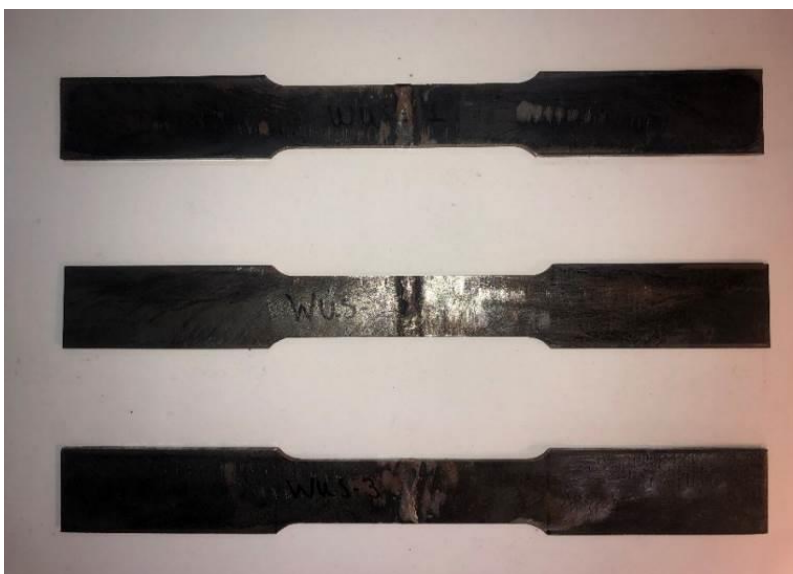
Εικόνα 5-3: Μορφή συγκολλητών δοκιμίων (WUS).
