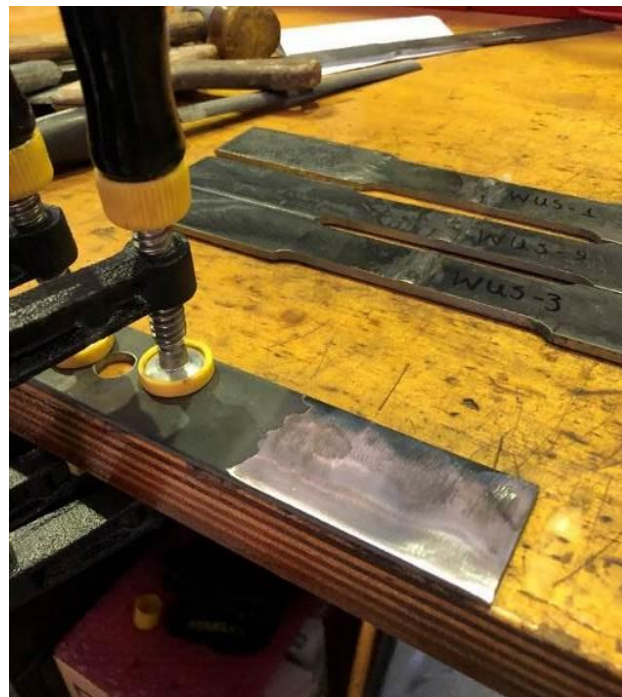
Εικόνα 5-6: Δοκίμιο μετά την λείανση.
