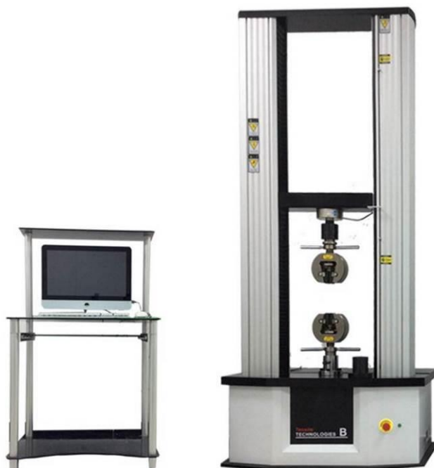
Εικόνα 4-5: Τυπική ηλεκτρονική μηχανή εφελκυστικής δοκιμής [Πηγή: instron.com].
