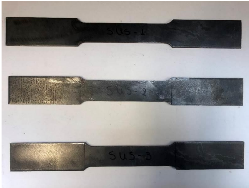
Εικόνα 5-2: Μορφή απλών δοκιμίων (SUS).
