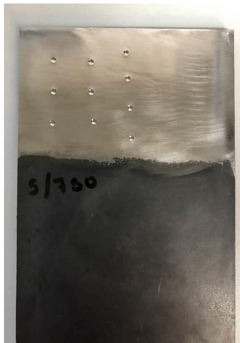
Εικόνα 5-9: Αποτυπώματα μετά την εφαρμογή της δύναμης στο σκληρόμετρο πάγκου.
