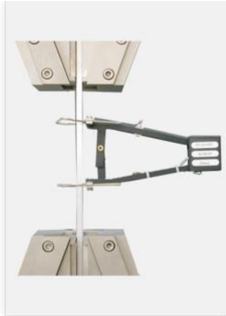
Εικόνα 4-4: Μηκυνσιόμετρο σε δοκίμιο [Πηγή: daksystem.com].
