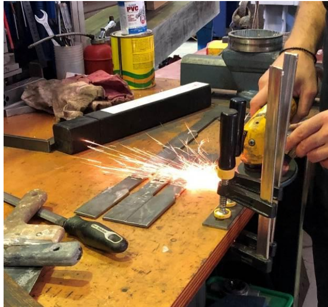
Εικόνα 5-5: Λείανση δοκιμίων στο εργαστήριο.
