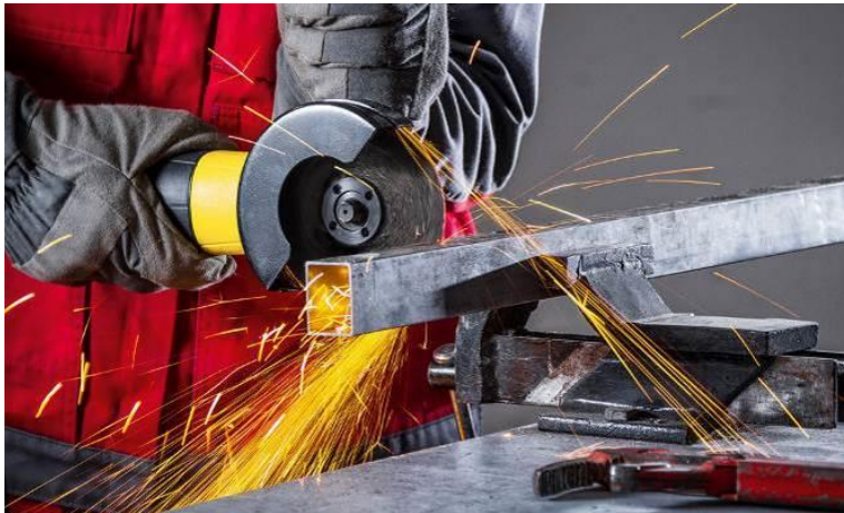
Εικόνα 4-6: Κοπή ελάσματος με τροχό [Πηγή: trotec.com].
