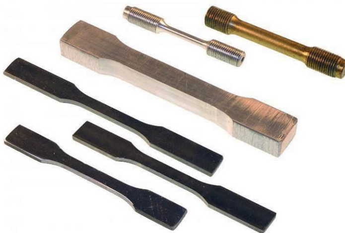
Εικόνα 4-8: Μεταλλικά δοκίμια κατάλληλα για εφελκυστικές δοκιμές [Πηγή: hill-engineering.com].
