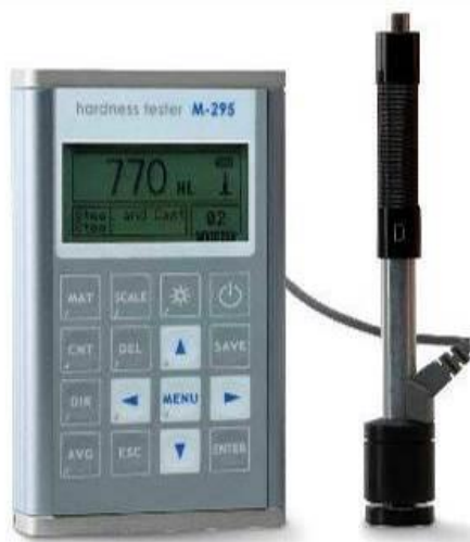
Εικόνα 3-7: Τυπικό φορητό όργανο σκληρομέτρησης [Πηγή: Direct Industry].
