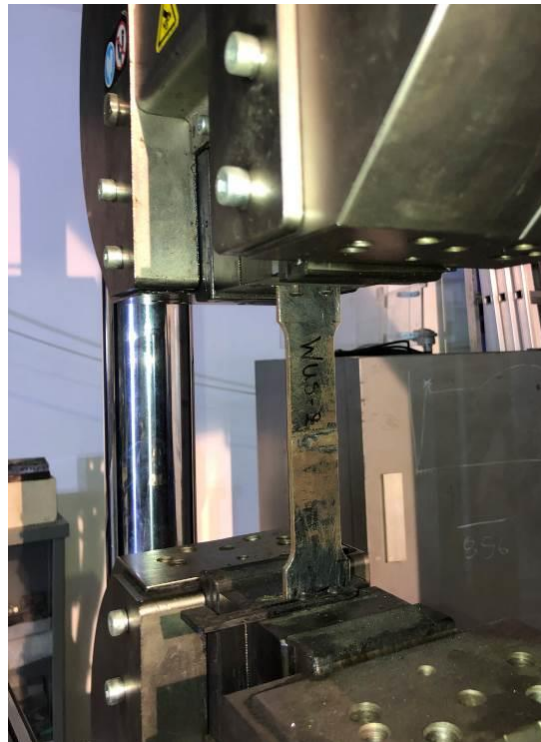
Εικόνα 6-16: Δοκίμιο WUS2 πριν την εφελκυστική δοκιμή.
