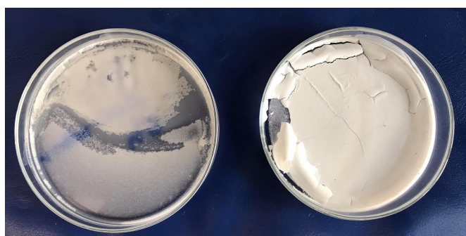
Εικόνα 36: Μορφολογία τελικού προϊόντος πειραμάτων: 95 °C, 200 mbar, 6 h (αριστερά) και 90 °C, 20 mbar, 6 h (δεξιά).
