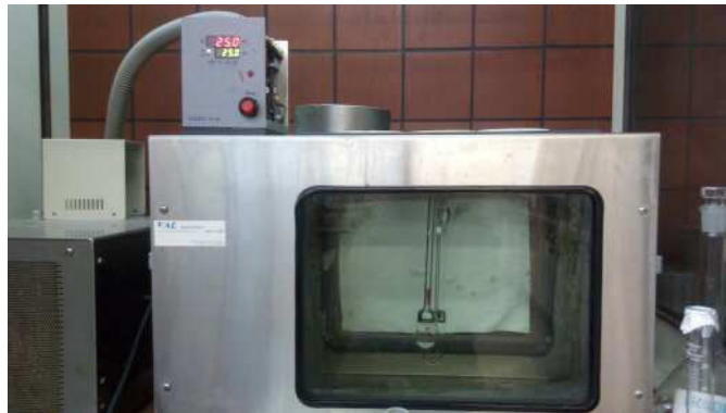
Εικόνα 34: Ιξωδόμετρο τοποθετημένο μέσα σε υδατόλουτρο
