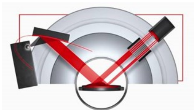
Σχήμα 4.12 Γεωμετρία διάταξης συσκευής D8 Advance, Bruker. Theta/Theta geometry [141].
