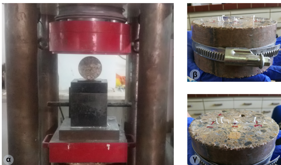
Σχήμα 4.11 (α) Πειραματική διάταξη τεχνητής ρηγμάτωσης. Στη διάταξη παρατηρείται τοποθετημένο αδιάρρηκτο δείγμα σκυροδέματος. (β) Δείγμα σκυροδέματος δεμένο με ανοξείδωτο μεταλλικό σφικτήρα. Οι λευκοί "σταλαγμίτες" αποτελούν το δευτερογενές υλικό πλήρωσης της ρωγμής. Το δείγμα είναι στραμμένο ανάποδα. (γ) Θέσεις μέτρησης, σημειωμένες με κόκκινο χρώμα στην κάτω επιφάνεια του δείγματος. Ομοίως και στην άνω επιφάνεια.
