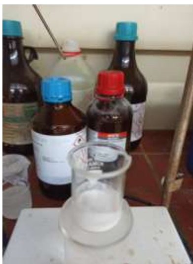
Εικόνα 21. Αιώρημα τιτανίας-περλίτη με αιθανόλη και νιτρικό οξύ υπό ήπια ανάδευση 8rpm
