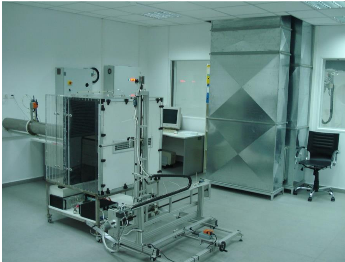
Εικόνα 9732: Μετρητική διάταξη αεροσύραγγας
