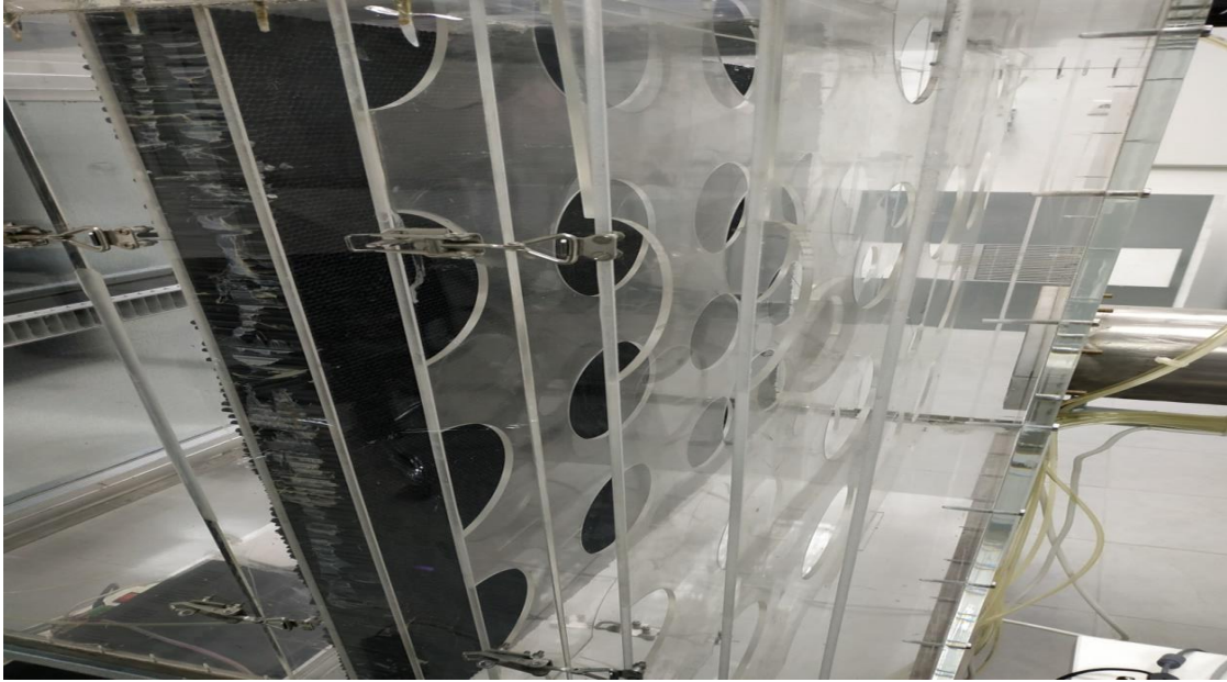
Εικόνα 9934: Πλάκες ισοκατανομής στο plenum box
