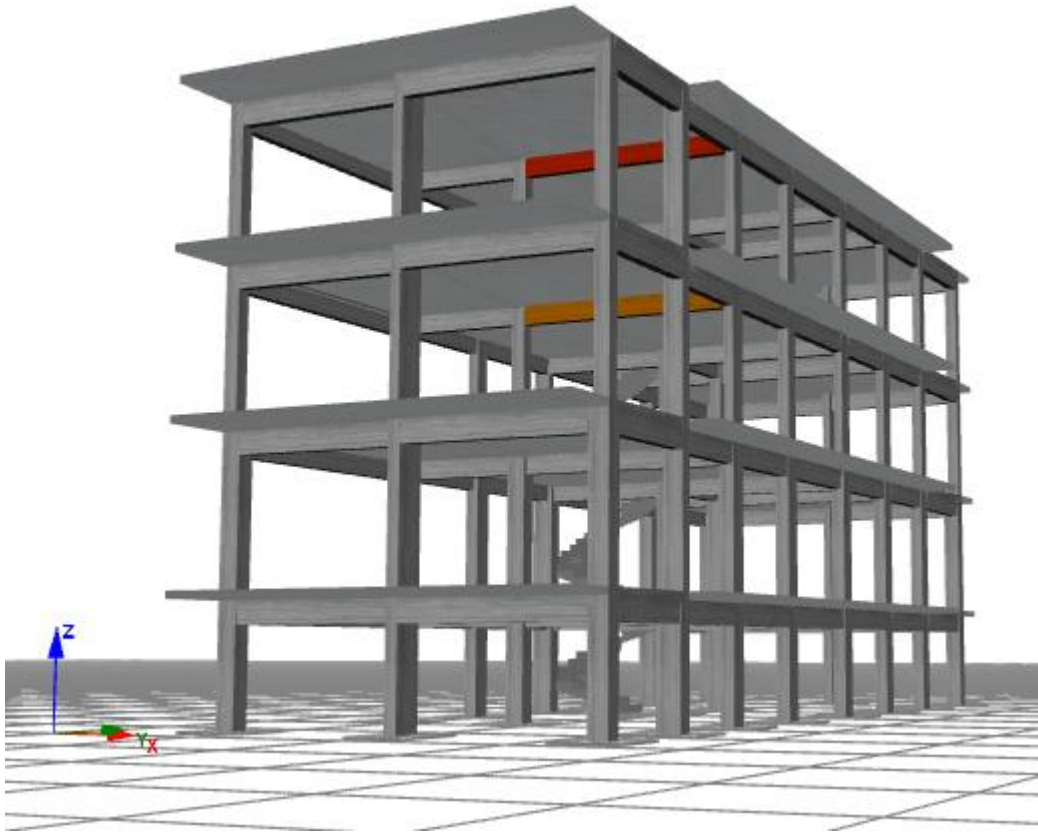
Σχήμα 2.5: Απεικόνιση φορέα για έλεγχο Στροφής Χορδής – Β2
