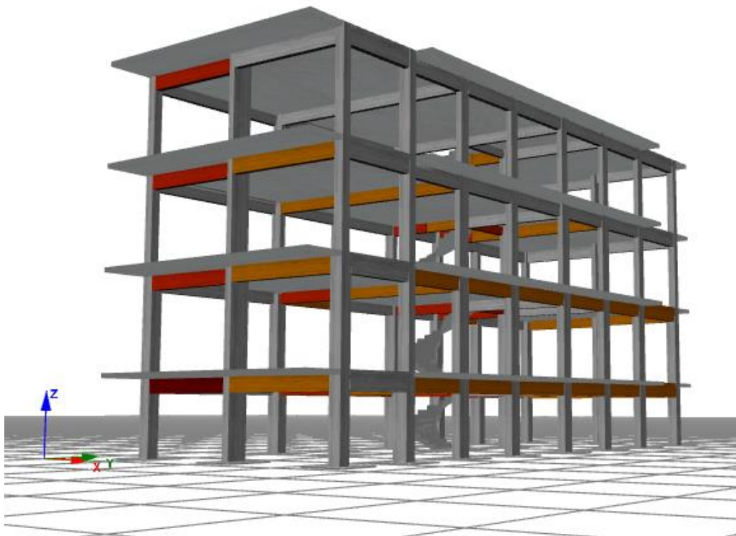
Σχήμα 2.6: Απεικόνιση φορέα για έλεγχο σε Τέμνουσα – Β2
