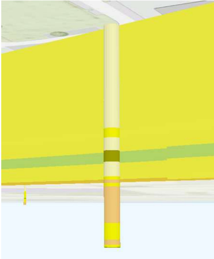
Εικόνα 15: Τομή υποεπιφανειακού γεωλογικού μοντέλου με γεώτρηση. Πηγή: https://pro.arcgis.com .
