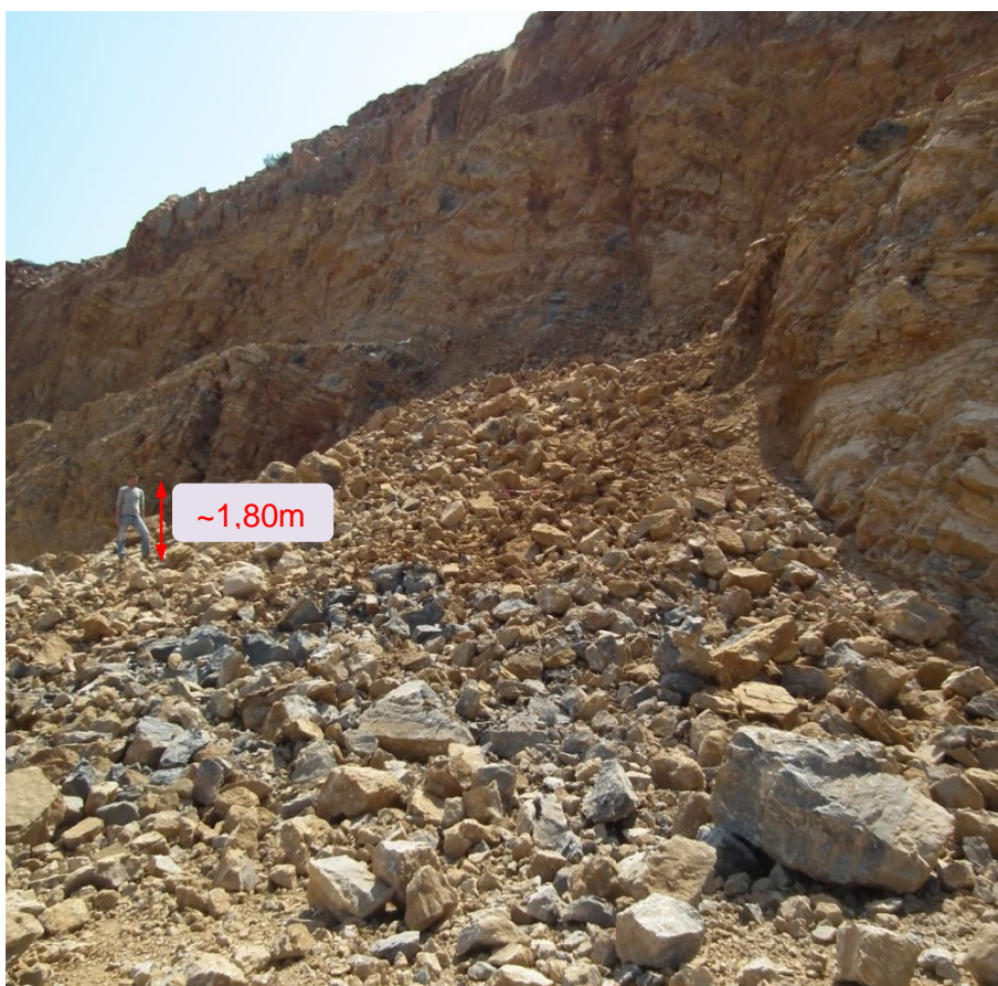
Εικόνα 6. Τυπικά ασβεστολιθικά προϊόντα ανατίναξης (Μαγούλα)
